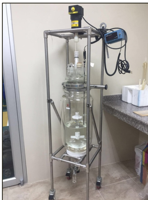
Figura 1. Reactor Batch marca ACE GLASS (68617) en LOPU
