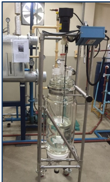
Ilustración 5. Reactor Batch en operación junto al intercambiador de calor. Elaborado por: Byron Calderón M.
