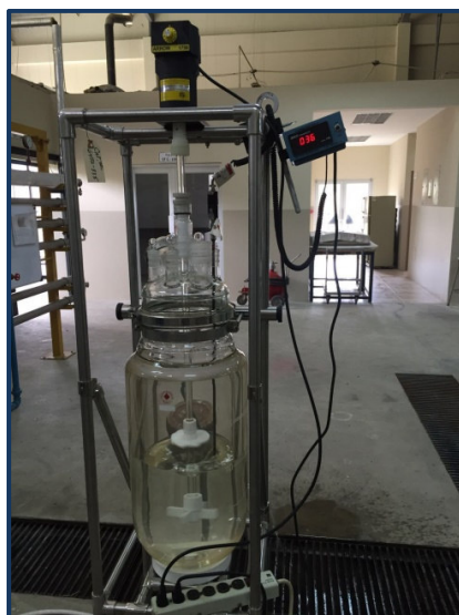
Ilustración 6. Reactor batch en operación – Esterificación del Etanoato de Etilo. Elaborado por: Byron Calderón M.
