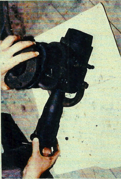
DESARMANDO EL QUEMADOR, OBSERVAMOS LAS CONEXIONES QUE CONTROLAN EL FLUJO DE AIRE PRIMARIO Y SECUNDARIO, VEMOS TAMBIEN LA ENTRADA DE COMBUSTIBLE.
