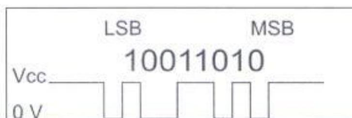
**Fig. 3.4.2.1.4.1.2 TTL bytes asincrónica No-invertida**
