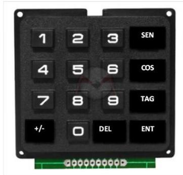
Figura 1-1 Teclado hexadecimal 4x4 utilizado en la implementación de este proyecto
