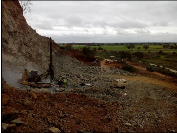
Imagen 2.4.- Perforadora y Compresor en frente de explotación (Autores, 2018)
