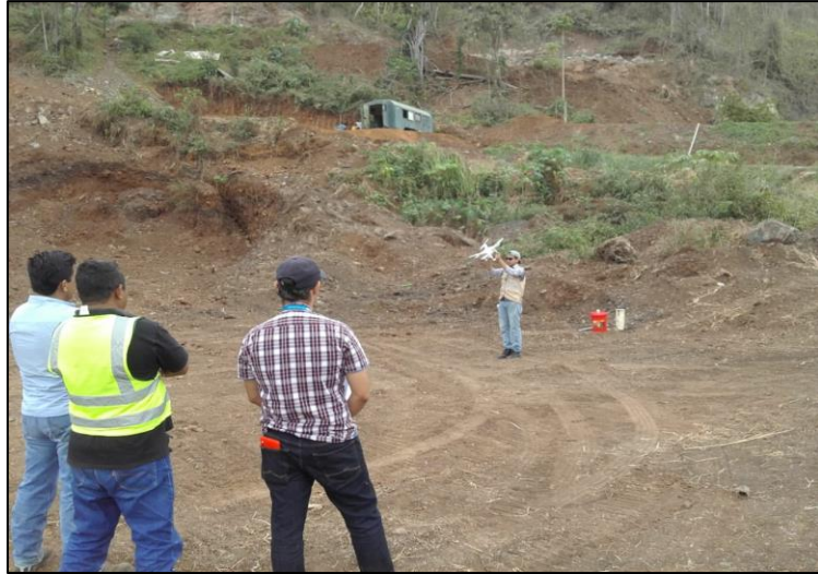
Imagen 2.3.- Calibración del drone en campo (Autores, 2018)
