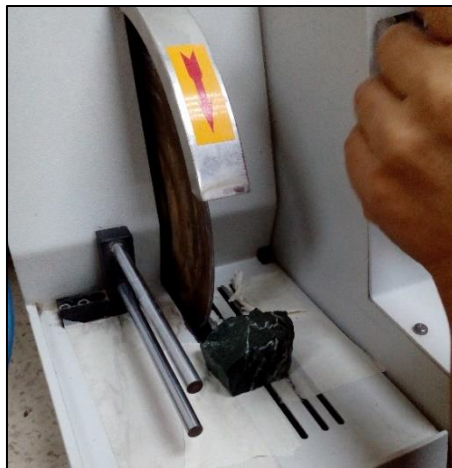
Imagen 2.12.- Disco cortador (Autores, 2018)
