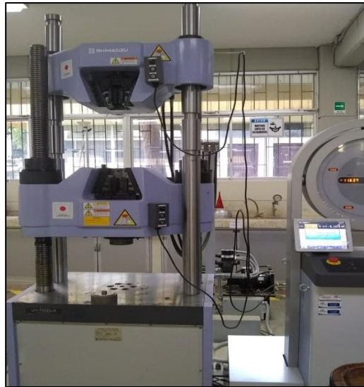
Imagen 2.19.- Máquina de compresión uniaxial Shimadzu (Autores, 2018)
