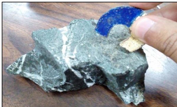
Imagen 2.7.- Ensayo de Magnetismo (Autores, 2018)
