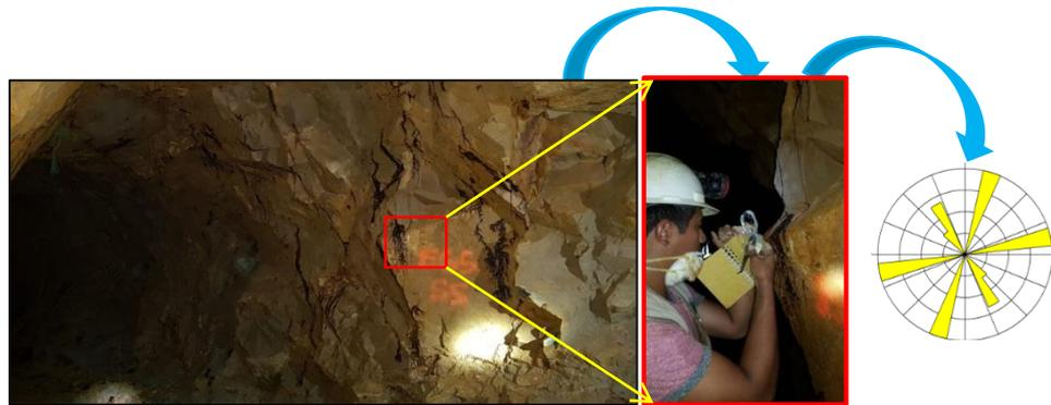
**Figura 3.7 Tendencia de fracturamiento en estación geomecánica.**
