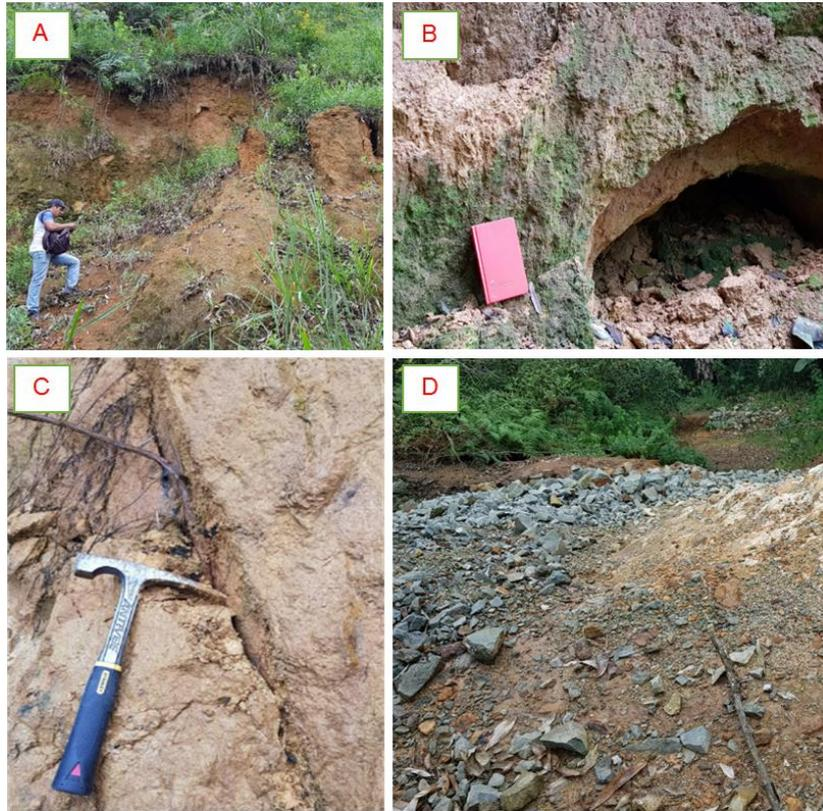
**Figura 3.1 Fotos tomadas en campo de diferentes estaciones con sus características más relevantes: a, deslizamiento; b, meteorización; c, plano de fractura; y d, escombrera.**
