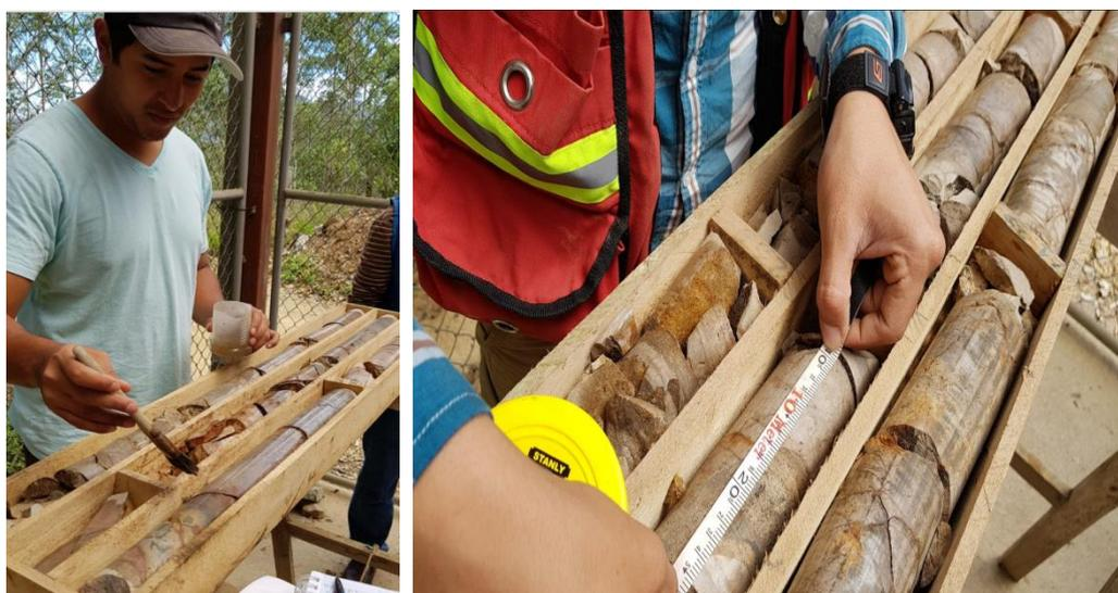
**Figura 3.3 Obtención de RQD en tramos de sondajes, reconociendo el tipo de litología y su nivel de fracturación.**
