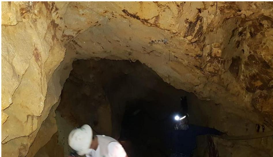
**Figura 4.7 Paredes con roca frágil en el sector A, correspondiente a la estación E.G 20 realizada en los trabajos en subterráneo.**
