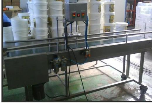
**Figura 3.5 Máquina tapadora de envases**
