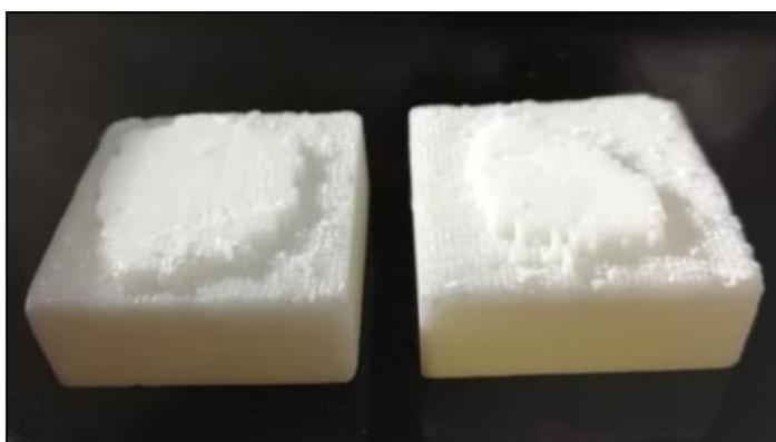
**Figura 2.12 Probeta de tecnología MJP para fresado.**
