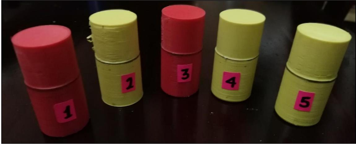
**Figura 0.7 Piezas de trabajo de la primera fase de ensayo de la tecnología FDM para torneado.**
