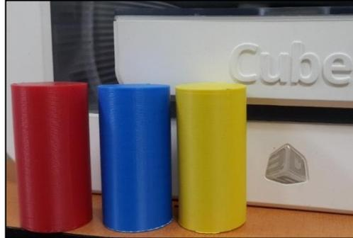
**Figura 2.9 Probetas de tecnología FDM para torneado.**
