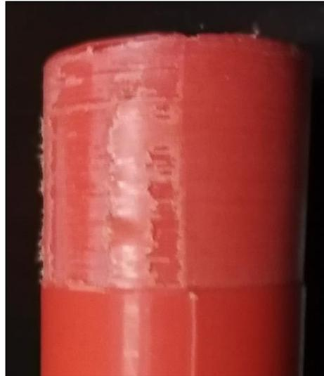
**Figura 0.11** Pieza de trabajo N.º 8 de la segunda fase de ensayo de la tecnología FDM para torneado, presenta fallas en la superficie.
