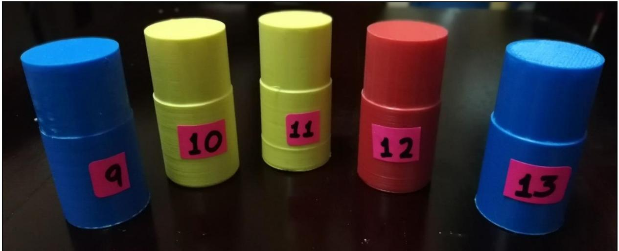
**Figura 0.13 Piezas de trabajo de la tercera fase de ensayo de la tecnología FDM para torneado y, la mejor probeta de la segunda fase (N.º9).**
