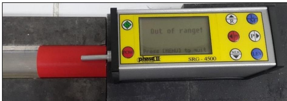
**Figura 0.2 Ilustración de una medición “Fuera de Rango” (F.R.) en una pieza fabricada por tecnología FDM.**
