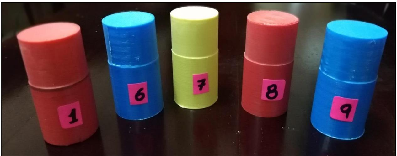
**Figura 0.10** Piezas de trabajo de la segunda fase de ensayo de la tecnología FDM para torneado y, la mejor probeta de la primera fase (N.º1).
