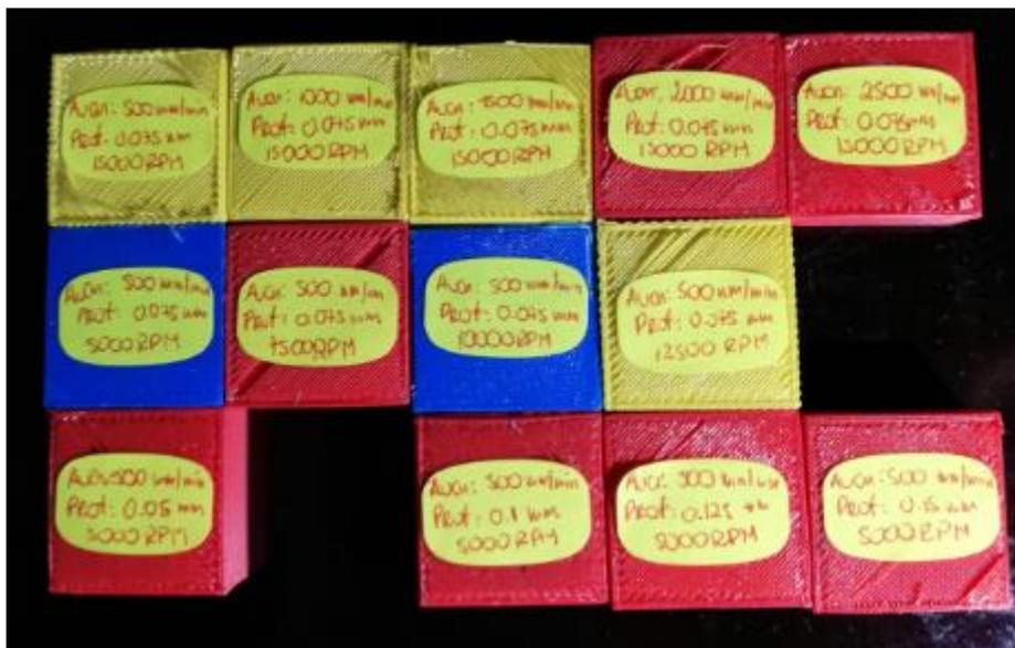
**Figura 0.20** Piezas de trabajo de la tecnología FDM para fresado, rotuladas.
