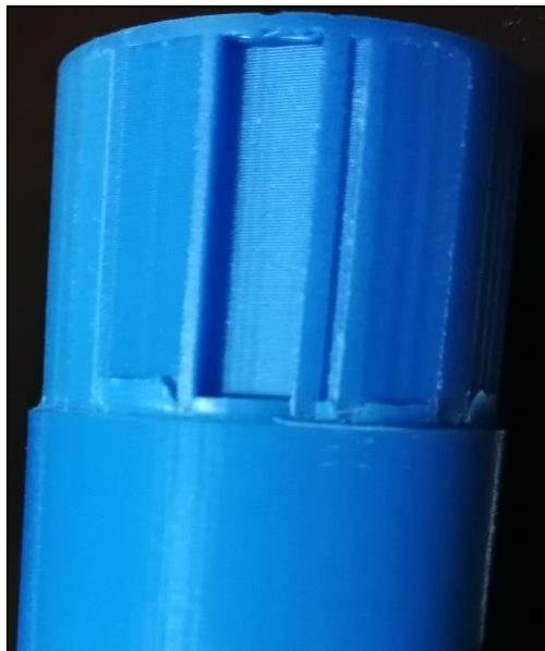
**Figura 0.14 Pieza de trabajo N.º 13 de la tercera fase de ensayo de la tecnología FDM para torneado, presenta fallas en la superficie.**
