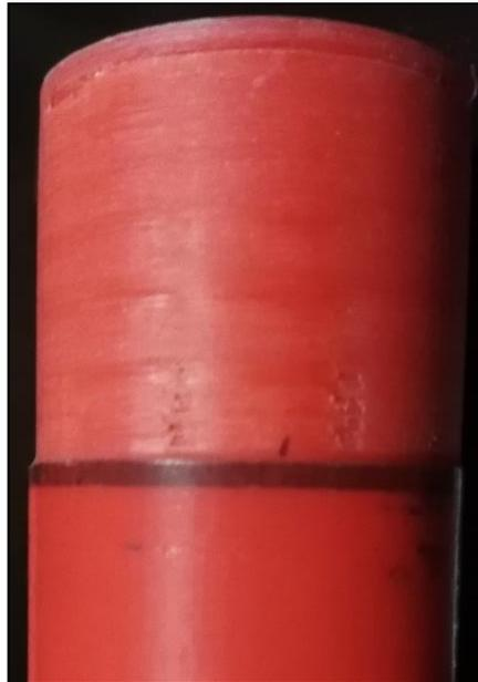
**Figura 0.8 Pieza de trabajo N.º 3 de la primera fase de ensayo de la tecnología FDM para torneado, presenta fallas en la superficie.**
