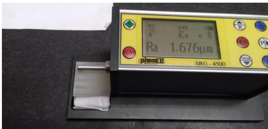
**Figura 0.24 Piezas de trabajo de la tecnología MJP para fresado, durante la medición de rugosidad superficial.**
