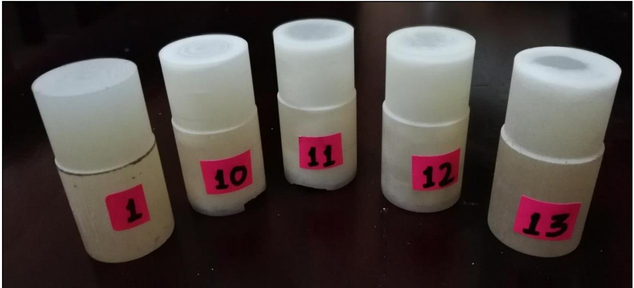
**Figura 0.12** Piezas de trabajo de la tercera fase de ensayo de la tecnología MJF para torneado y, la mejor probeta de la segunda fase (N.º1).
