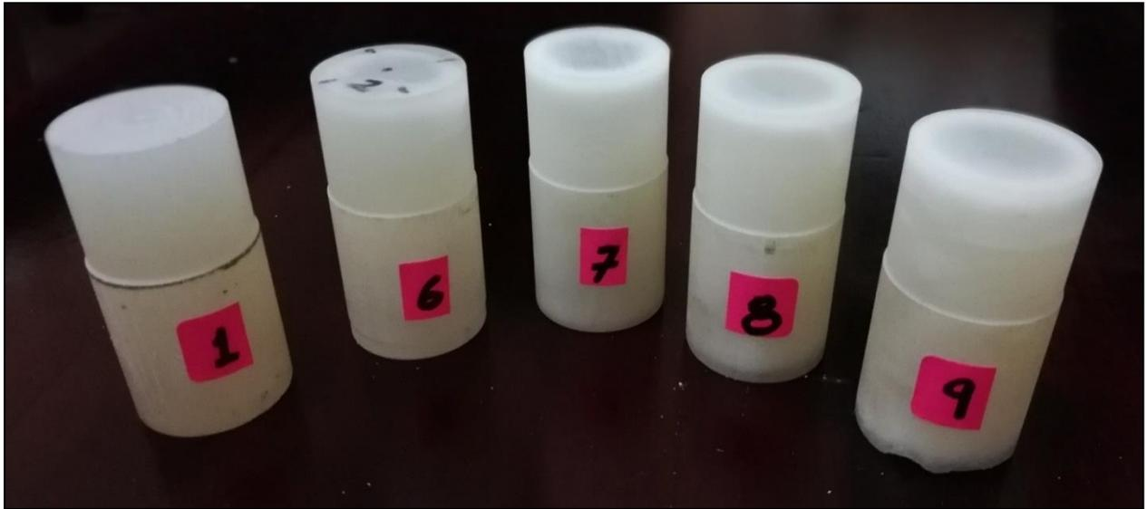
**Figura 0.9** Piezas de trabajo de la segunda fase de ensayo de la tecnología MJP para torneado y, la mejor probeta de la primera fase (N.º1).
