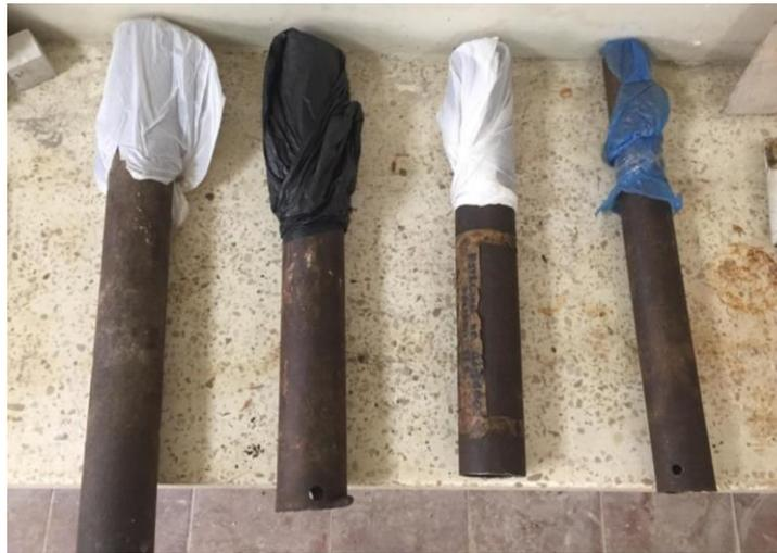
**Figura 2.7 Muestra inalteradas de Suelo.**
