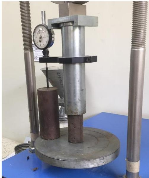
**Figura 1.10 Ensayo compresión simple**
