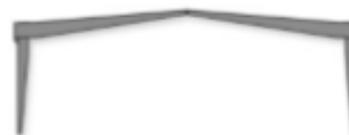
*Figura 2.9: Pórtico de perfil variable.*
