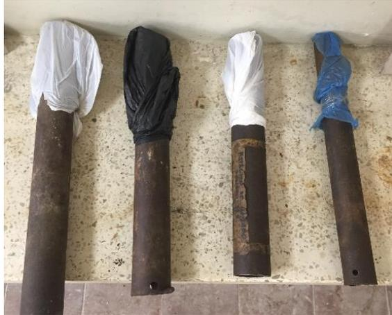
**Figura 1.9 Muestras inalteradas**
