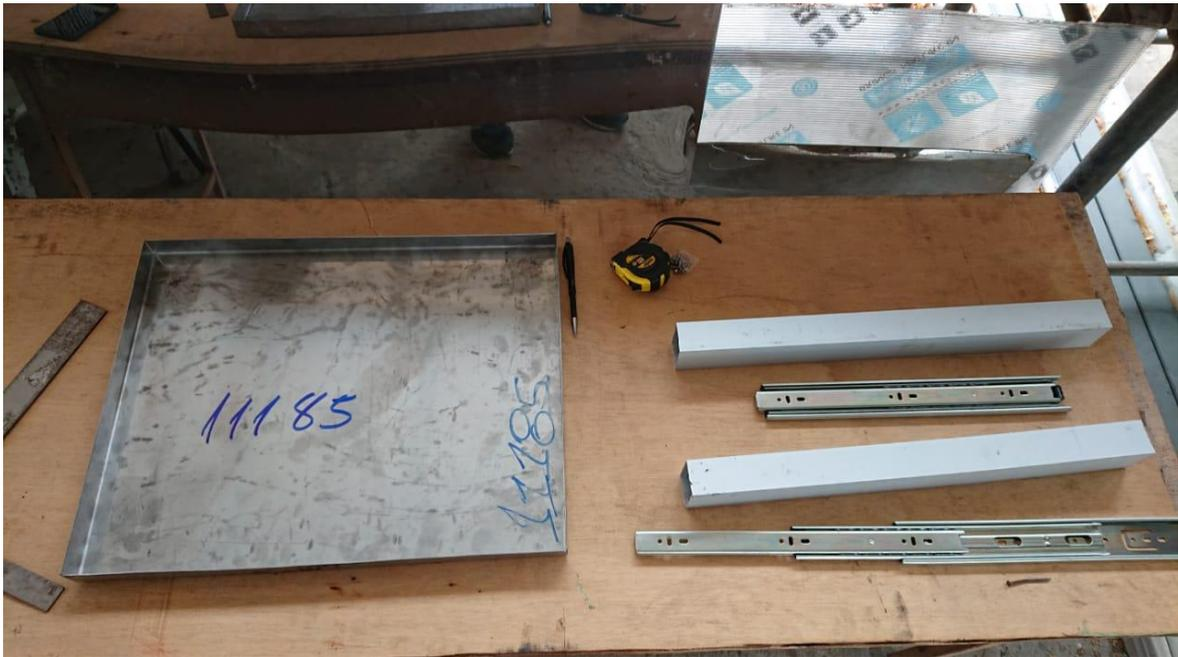
**Figura A. 5 Plataforma y rieles del tren de movimiento**
