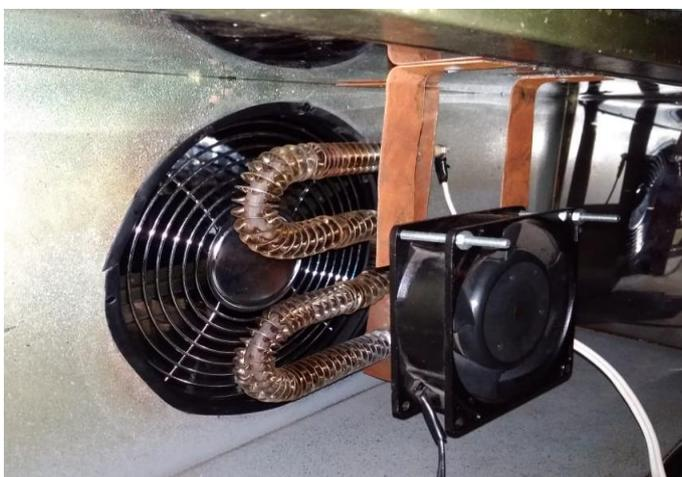
**Figura 3.22 Configuración ventilador-resistencia**
