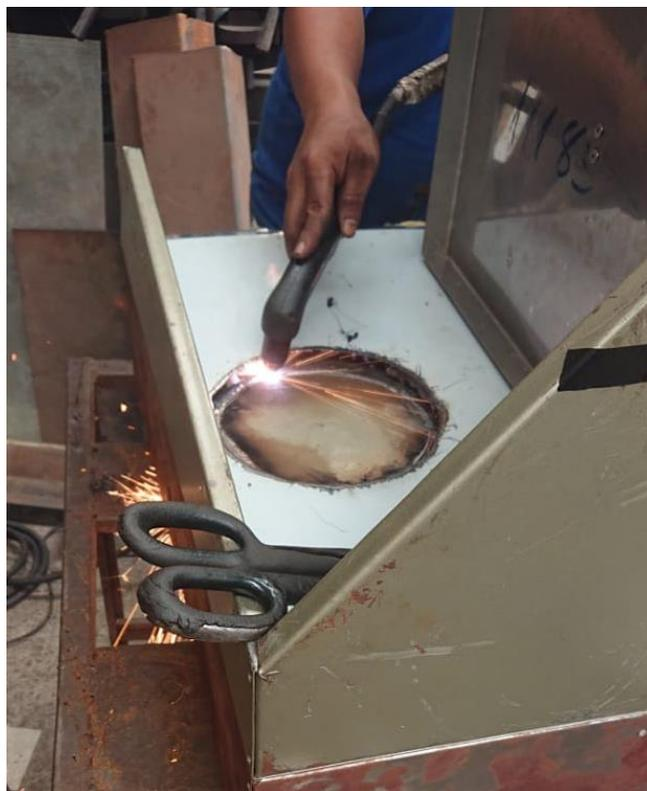
**Figura A. 4 Perforación para resistencia térmica**
