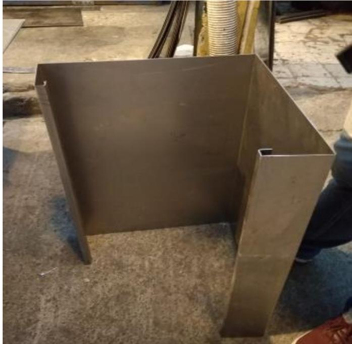
Figura A. 1 Doblado de lámina de acero
