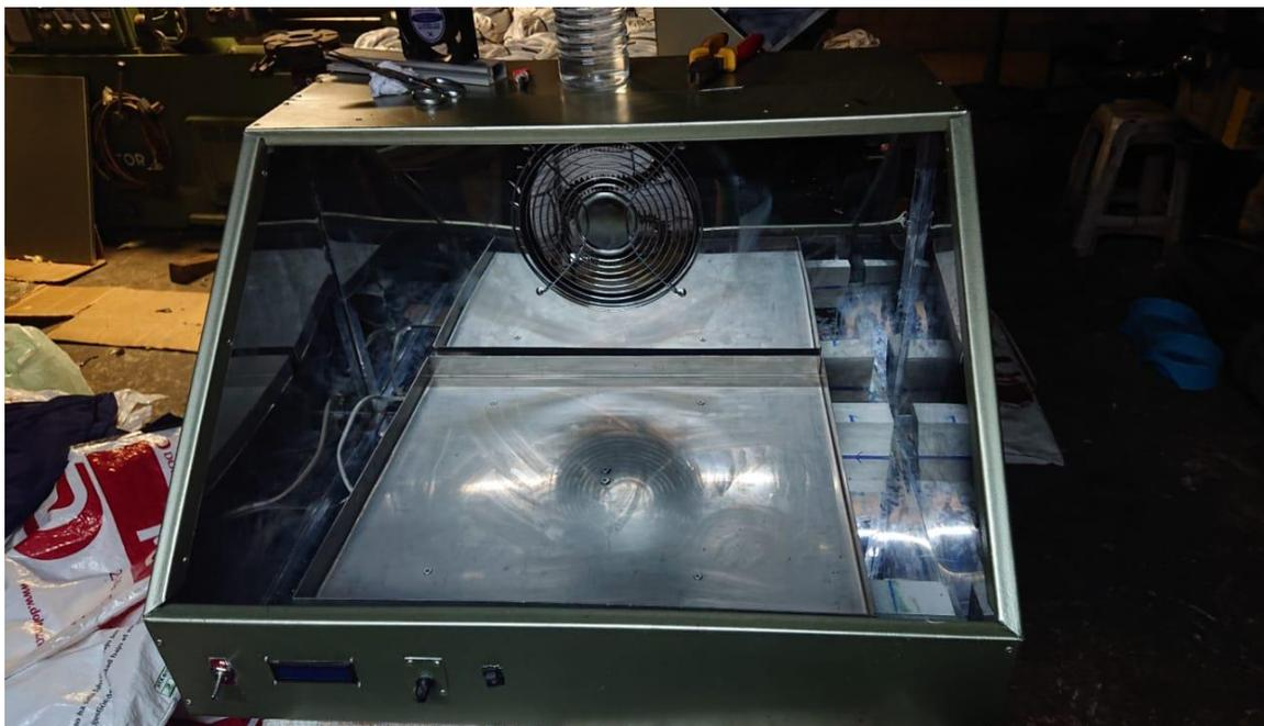
**Figura A. 6 Cámara de incubación sin tapa**
