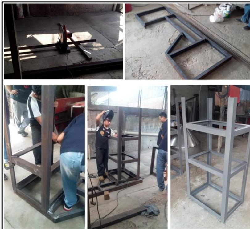
**Figura 0.3. Proceso de Fabricación de la Estructura de Soporte. Fuente: Elaboración propia**
