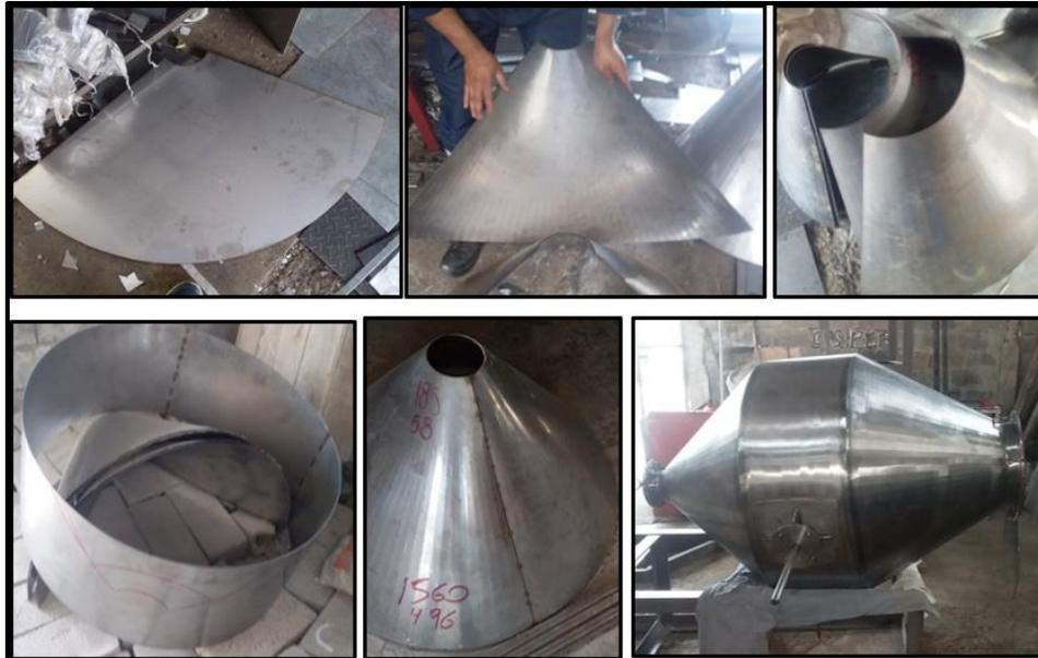
**Figura 0.2. Proceso de Fabricación del cono. Fuente: Elaboración Propia.**
