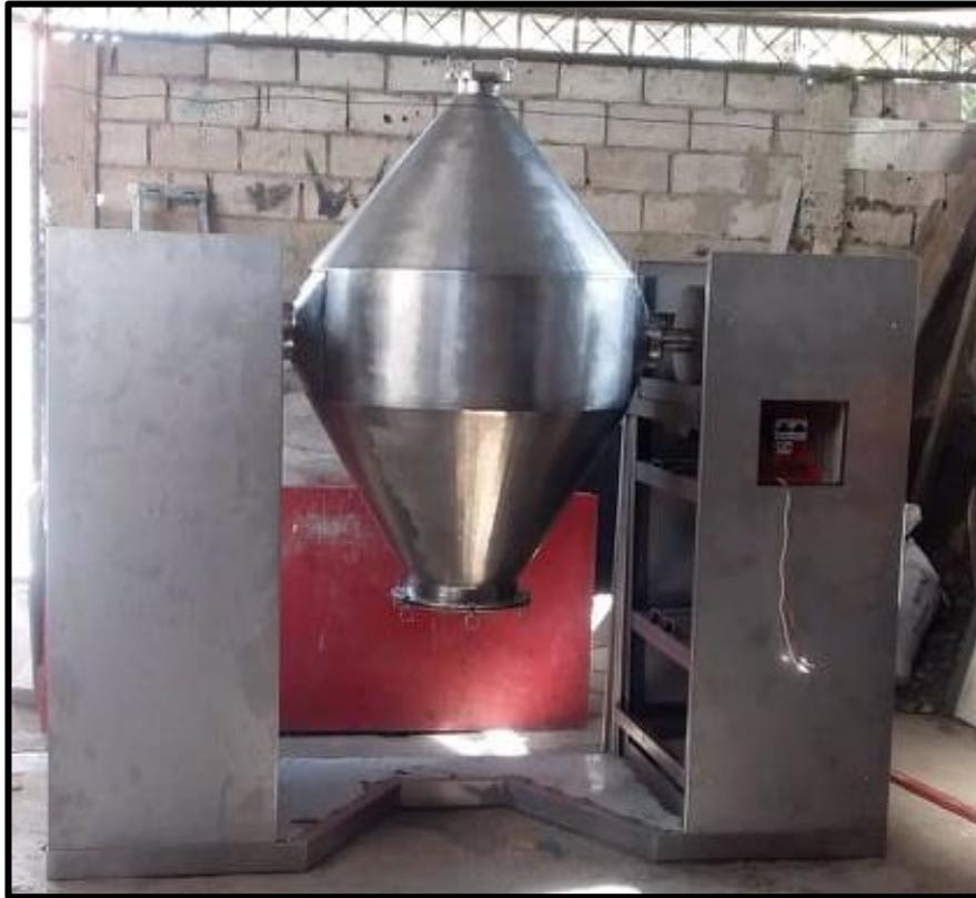
Figura 0.4. Foto del Mezclador de Doble Cono terminado. Fuente: Elaboración Propia.
