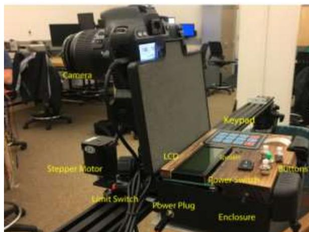
Figura 1.1. Componentes del prototipo deslizador de cámara automatizado.[1]
