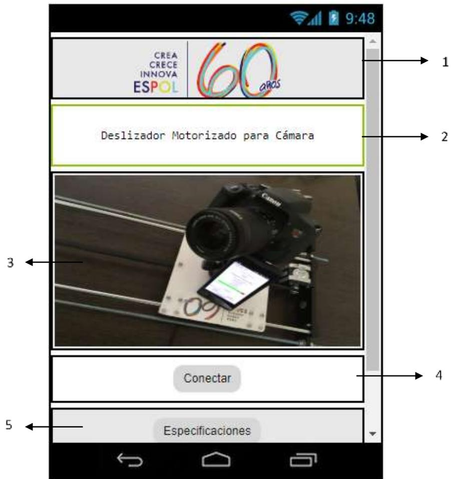
**Figura 3.5 Menú principal del aplicativo remoto. Los números muestran 1: Logo de la Escuela Superior Politécnica del Litoral. 2: Nombre del prototipo deslizador de cámara fotográfica 3: Ilustración del prototipo. 4: Botón de conexión del dispositivo. 5: Botón de especificaciones y modo de funcionamiento.**
