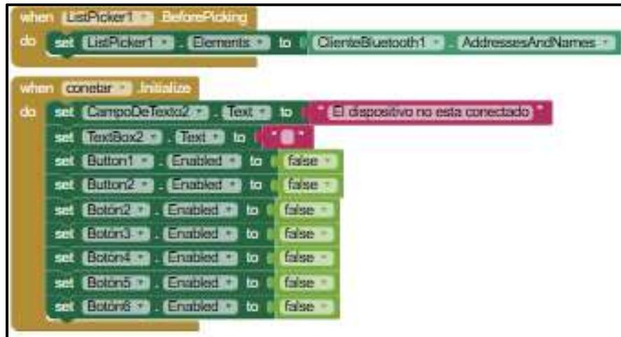
Figura A.3. Configuración de comunicación bluetooth
