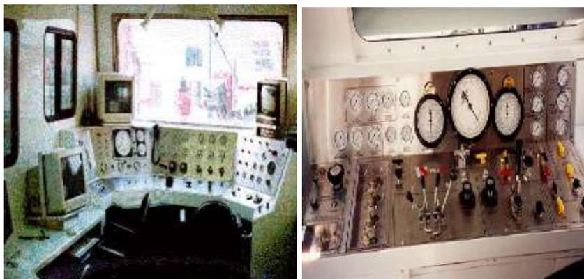
**Figura 2.10** Cabina de control del CTU
