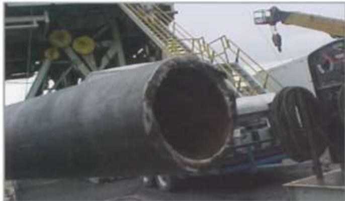
**Figura 2.15** Tubería cortada con herramienta
