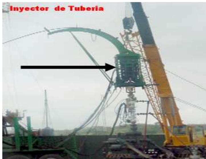
**Figura 2.4** Inyector de tubería del CTU
