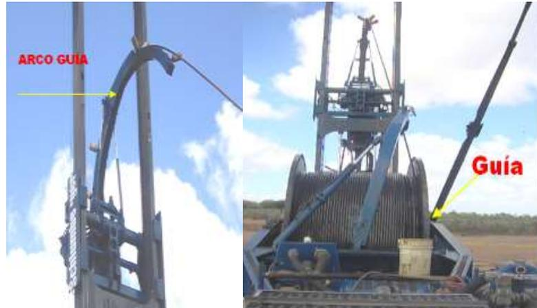
**Figura 2.5** Arco y guía nivelador del CTU
