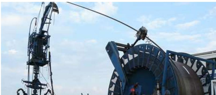
**Figura 2.1** Tubería flexible CT
