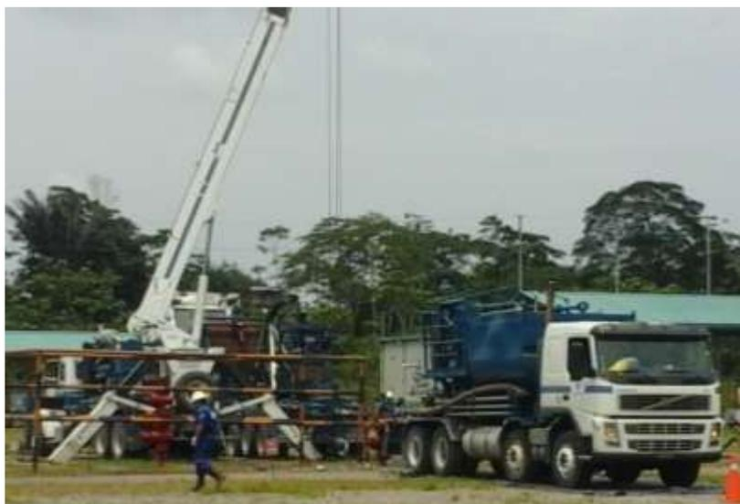
**Figura 2.2** Unidad de tubería flexible
