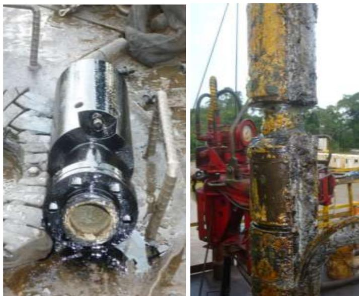
**Figura 3.4** Componentes de BES post *pulling*
