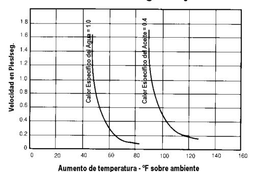
Fig. 7 Curva que relaciona la temperatura del motor en función a la velocidad de flujo. Fotografía de la compañía Baker Hughes
