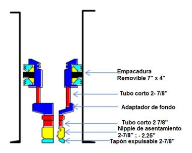
FIG 38.- Ensamblaje inferior a la empaquetadura
