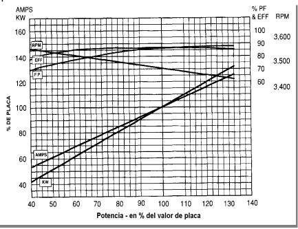
Fig. 5 Curvas características del motor electrosumergible en función de la carga.
