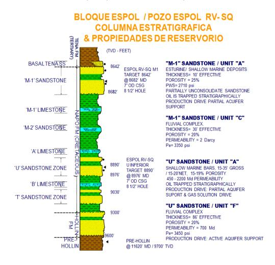
Figura 2 Columna Estratigrafica del pozo ESPOL RV-SQ
