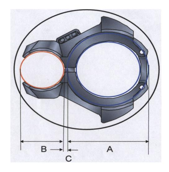
Fig. 30 Dimensionamiento de una grapa con respecto al espacio para el By-pass tubing (B), espacio para la bomba (A) , y espacio protector para el cable plano y los capilares, mientras que la parte C es una pequeña distancia entre el by pass tubing y el motor eléctrico.
