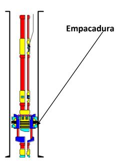
Fig 16.- Empacadura asentada en el CSG Fotografía de la compañía Schlumberger
