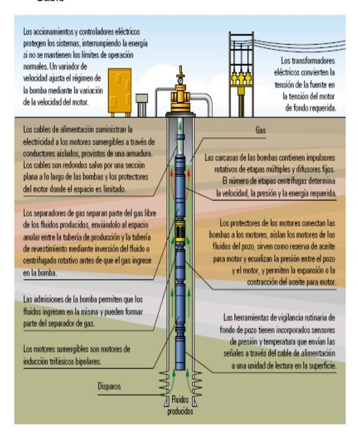
Figura 3.-Componentes del sistema eléctrico sumergible Fotografía de la compañía Schlumberger.
