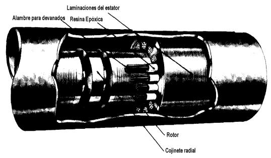
Fig. 5 - Conjunto Estator y Rotores de un motor
