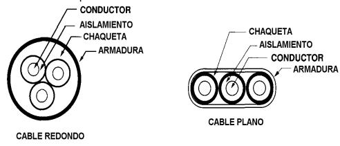
Fig. 14.-Tipos de cable eléctrico para Motor eléctrico sumergible.
