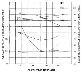
Fig. 6 Curva de variación del desempeño del motor en función a un voltaje variable. Baker Hughes
