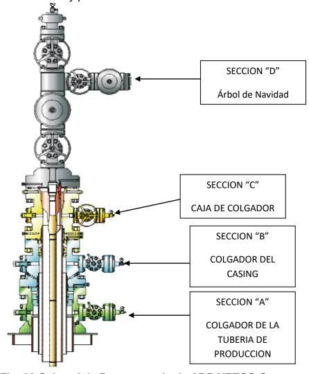
Fig. 36 Cabezal de Pozo, tomada de ABB VETCO Gray
