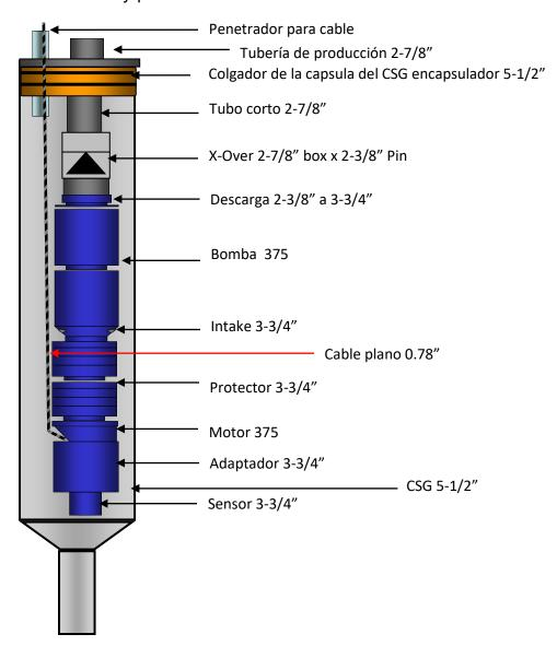
Fig. 40 Ensamblaje del equipo BES INFERIOR
