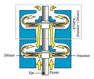
Fig. 9. - Constitución de una etapa de la Bomba eléctrica
