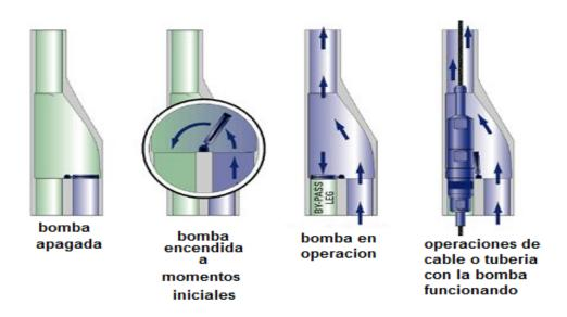
Fig. 27 Dirección del fluido dentro de la herramienta "Y" Fotografía proporcionada por la compañía Schlumberger
