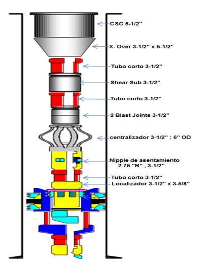
Fig. 39 Primera sección de completación dual, tubería de cola Figura de Edgar Villavicencio
