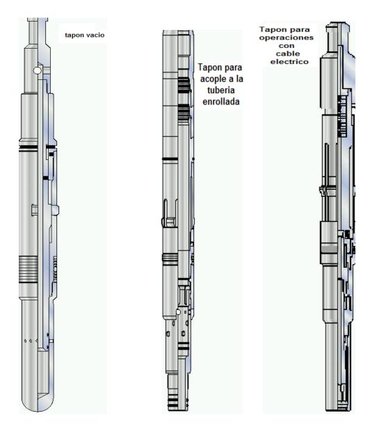
Fig. 22 Tapones para la tubería By pass
