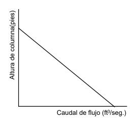
Fig. 10 Columna de fluido Vs. Caudal
