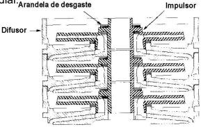
Fig. 9a -Comportamiento del flujo radial en una etapa.
