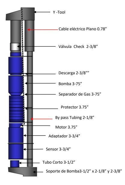
Fig. 42 Ensamblaje del equipo BES SUPERIOR
