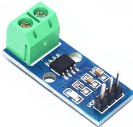
**Figura 4.5. Transductor de Corriente ACS712.**
