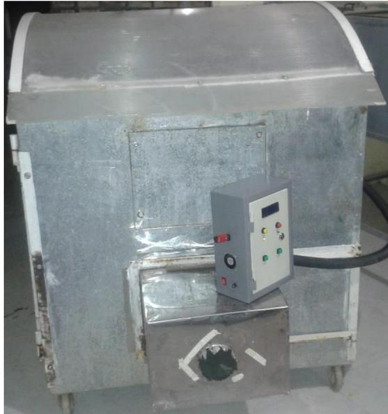
**Figura 4.6. Caja de procesamiento instalada con el secador**
