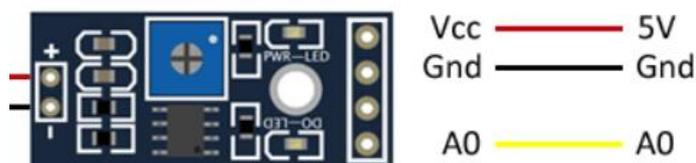
**Figura 3.6. Esquemático del sensor de humedad**
