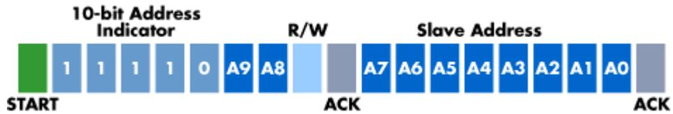
Figura 2.5. Direccionamiento de trama de 10 bits [2]
