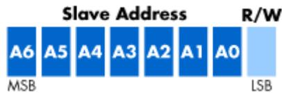
Figura 2.3. Direccionamiento de trama de 7 bits [2]
