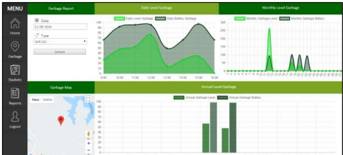
Figura 3.12 Gráfica de consumo de energía y sensado de contenedores
