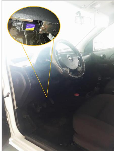
**Figura 3.2. Localización del conector DLC OBD-II**
