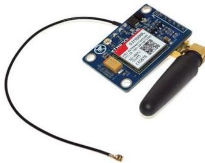
**Figura 3.4. Módulo GSM Sim800L [22]**
