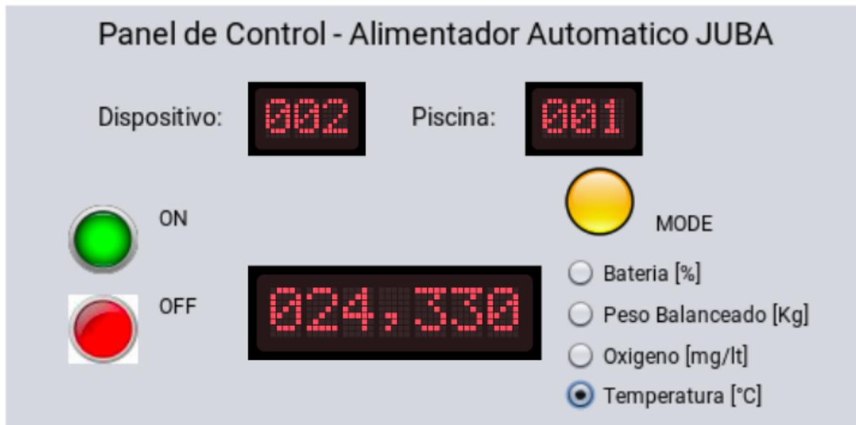
Figura 3.16 Panel de control del Alimentador Automático
