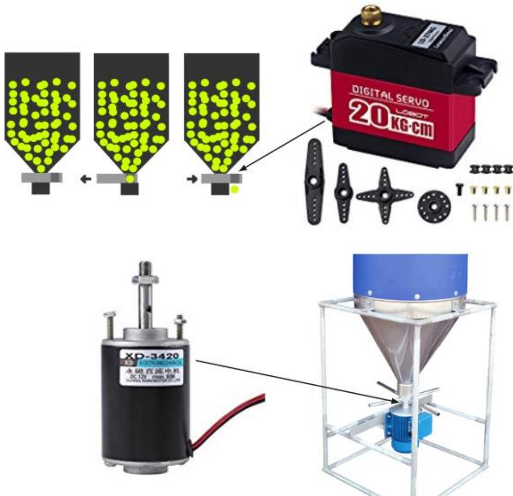
**Figura 3.6** Módulo de dispensador y dosificador de balanceado (Google Imágenes, 2018)
