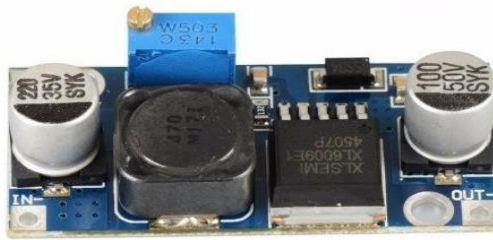
Figura 2.7 Convertidor DC-DC elevador XL6009
