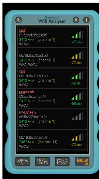
Figura 43 – Lectura de señales detectadas con aplicación Wifi Analyser durante las pruebas de campo en el Centro Integral de Equinoterapia
