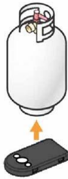
Figura 1.2 Sensor imantado colocado en la base del cilindro de gas
