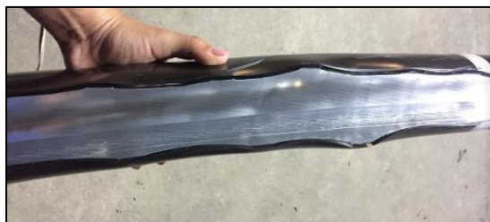
Figura 3.40 Desprendimiento de capa exterior.
