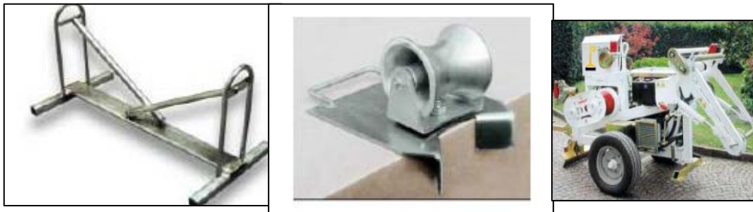
Figura 3.50 Accesorios y herramientas para el tendido del cable NKT(2018).
