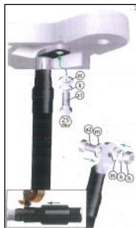
Figura 3.35 Conexión a tierra NKT (2018).
