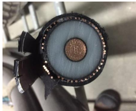
Figura 3.1 Cable XLPE subterráneo 84 kV
