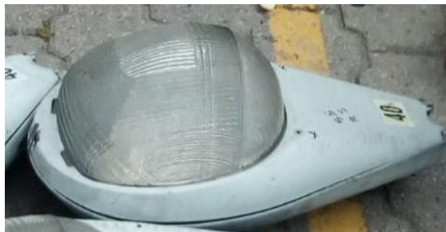
Figura 1.1. Luminaria de sodio de alta presión de 400W
