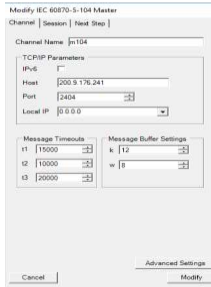
Figura 3.15 Configuración del protocolo IEC 104
