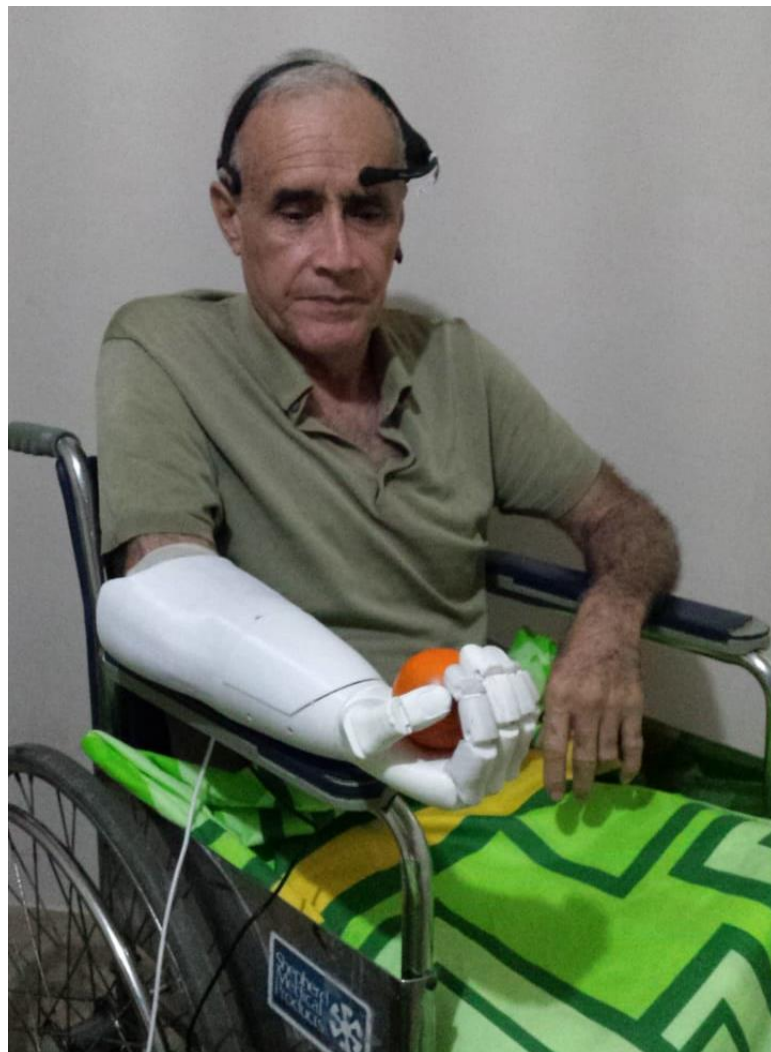
Figura 4.1. Accionamiento de la prótesis para la persona con amputación mediante sus ondas neuronales.
