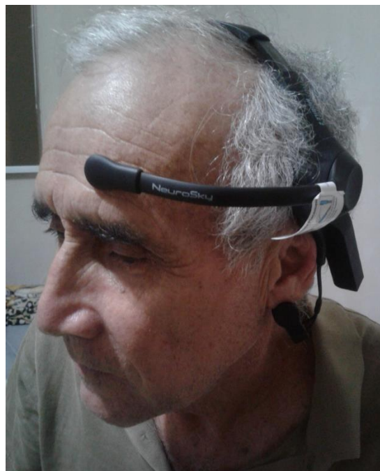
Figura 4.4. Dispositivo Neurosky colocado correctamente en la cabeza.
