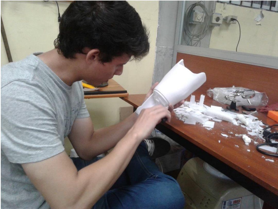
Figura 9. Eliminación de material de soporte en el antebrazo impreso.
