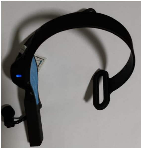
Figura 4.2. El LED azul indica que el Neurosky está con batería completa.
