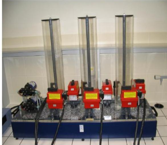
Figura 1.2. Amira DTS200, sistema de tres tanques
