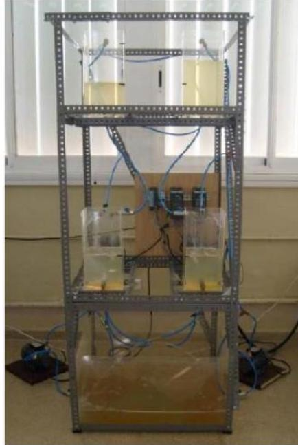
Figura 2.10 Instalación de laboratorio de cuatro tanques como sistema multivariable.
