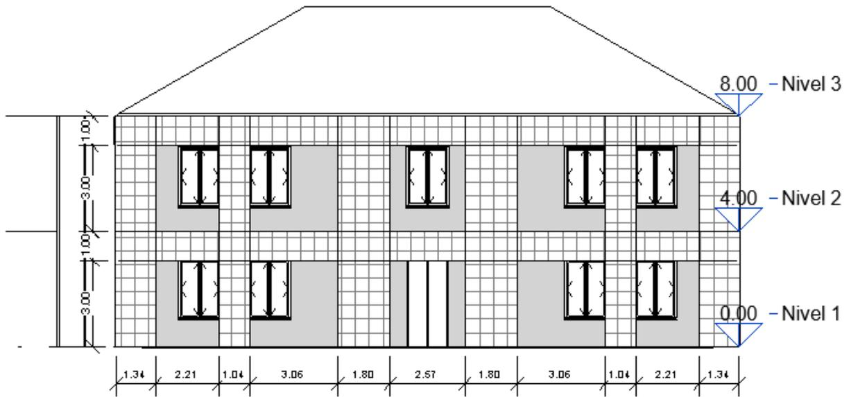
**Figura 3.17 Fachada frontal de la estructura con refuerzo de malla electrosoldada**
