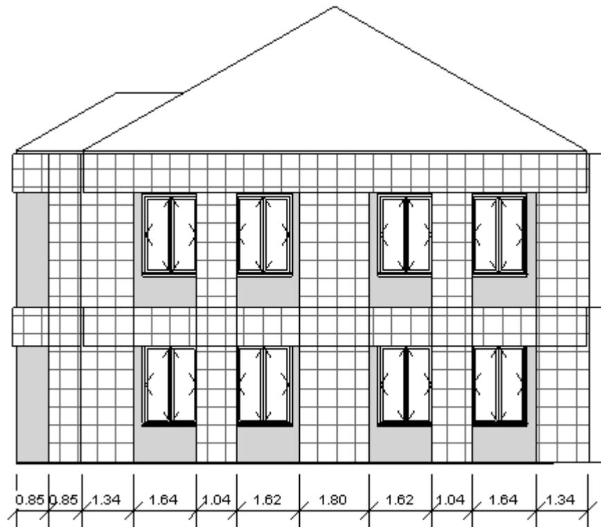
**Figura 3.18 Fachada lateral de la estructura con refuerzo de malla electrosoldada**
