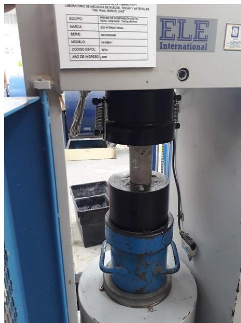
**Figura 2.20 Rotura de cilindros**
