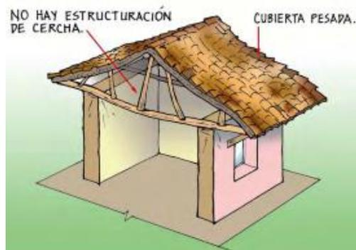
Figura 1.9 Cubierta pesada (Arias, 2004)
