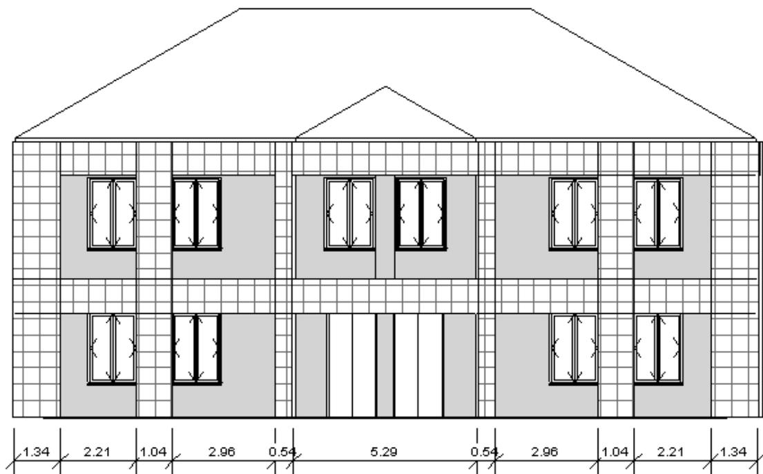
**Figura 3.19 Fachada posterior de la estructura con refuerzo de malla electrosoldada**
