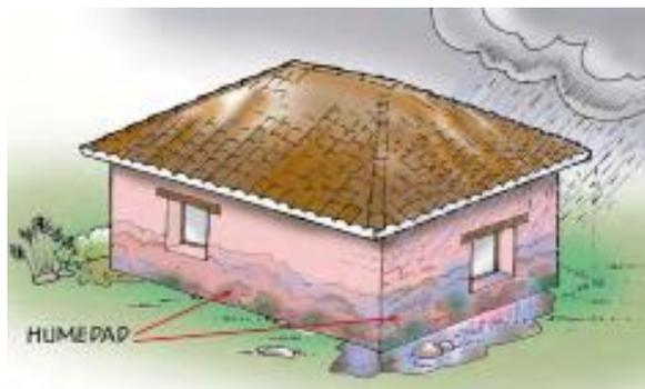
**Figura 1.5 Humedad en muros (Arias, 2004)**
