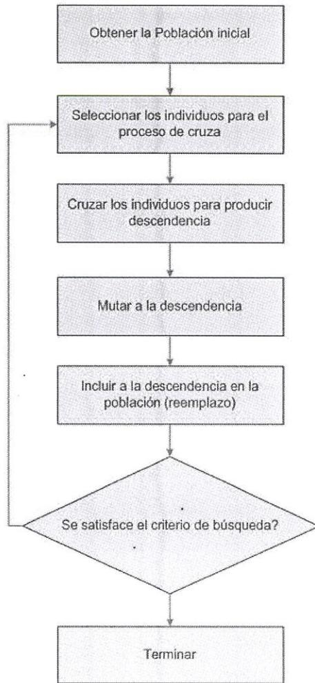
Figura 1.4: Ejecución general de un Algoritmo Genético
