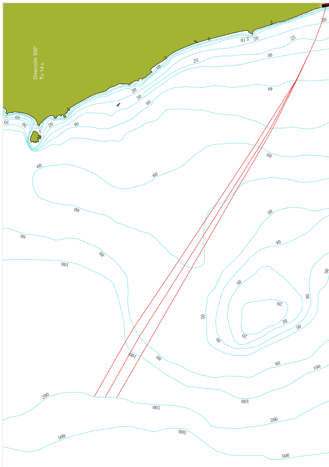
Figura 3.25 Refracción correspondiente a un ángulo de aproximación de 300° y un periodo de T=14 s.
