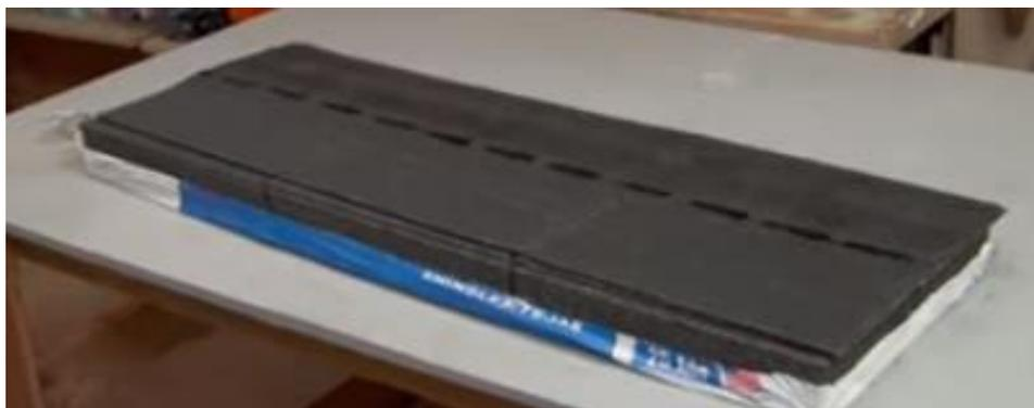
Gráfico 4.1. Figura referencial de la cubierta de Ecotechos. Dimensiones: 900x300mm, 15mm de espesor. Tomado de <https://www.youtube.com/watch?v=3bQPEEtWGKU>.
