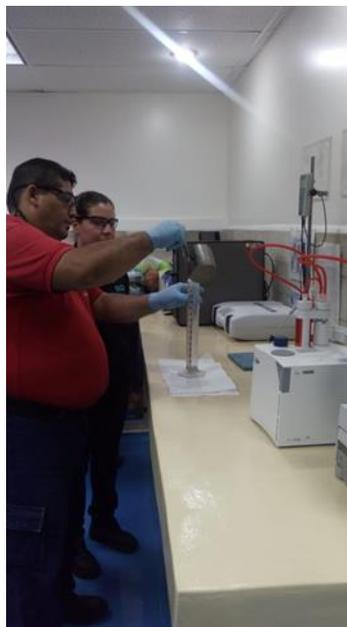
**Figura 2.28: Prueba de viscosidad al silicato líquido**
