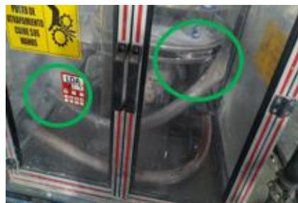
**Figura 2.37: Punto de aspiración dentro del sistema dosificador**
