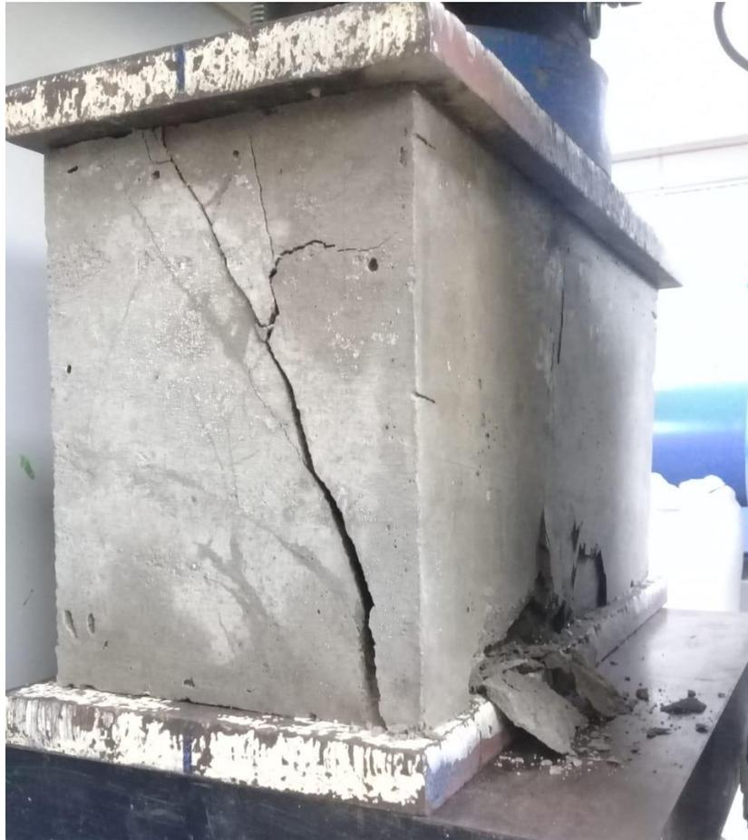
**Imagen 3.6 Rotura a compresión de bloque EPS.**
