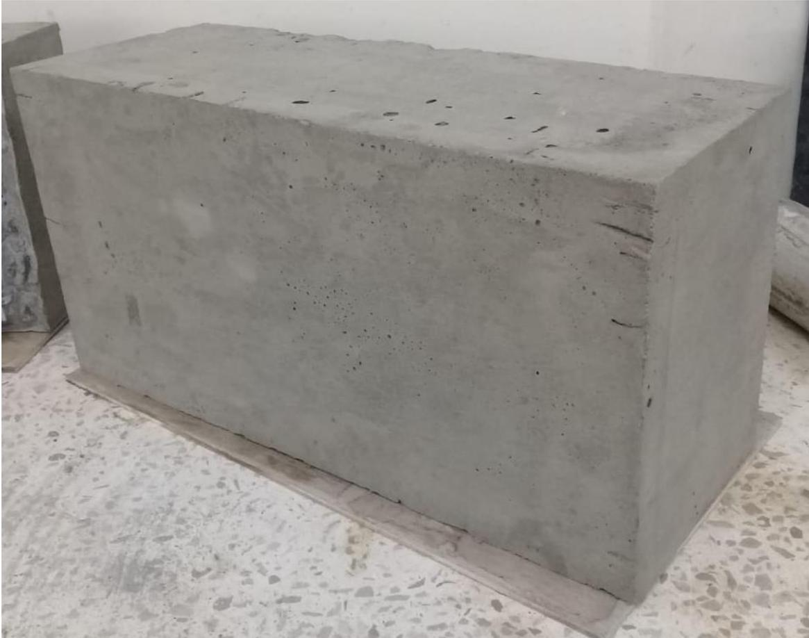
**Imagen 3.5 Bloque EPS recubierto con mortero**
