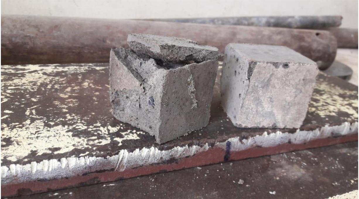
**Imagen 3.4 Cubo de ensayo de mortero**
