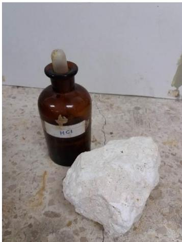
**Ilustración 2-5. Ensayo de Reactividad**
