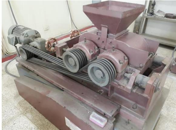
**Ilustración 2-10. Triturador de rodillos**
