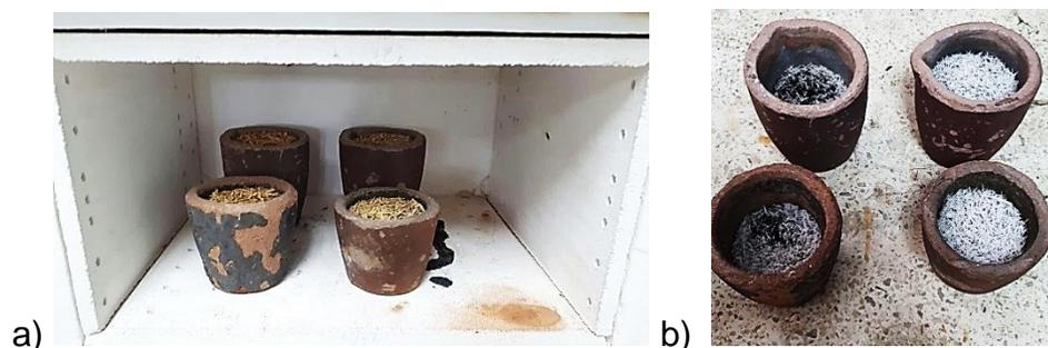
**Figura 29 Calcinación. a) Muestras a 500 °C antes de calcinación y b) después de la calcinación.**
