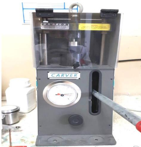
**Figura 36: Equipo para prensar las pastillas**
