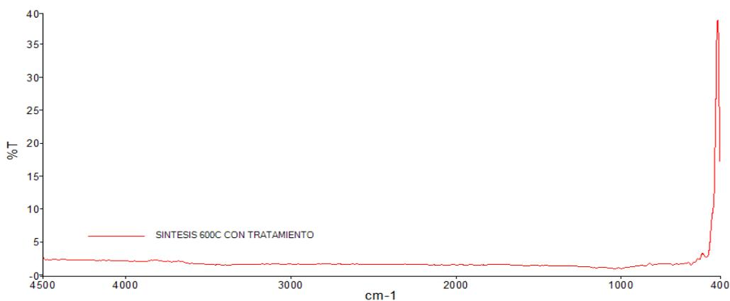
**Figura 74: FTIR de la muestra sintetizada proveniente de la CCA CT 600°C**
