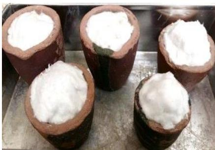
**Figura 30. Crisoles de alúmina envueltos en lana cerámica dentro de crisoles de ladrillo refractario antes de la síntesis.**
