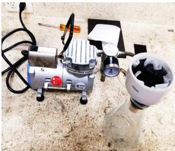
**Figura 31. Equipo de filtración al vacío totalmente ensamblado.**
