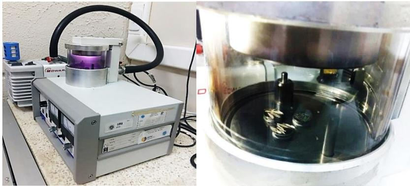
**Figura 32. Equipo sellador de oro/paladio con muestras a bajas temperaturas.**
