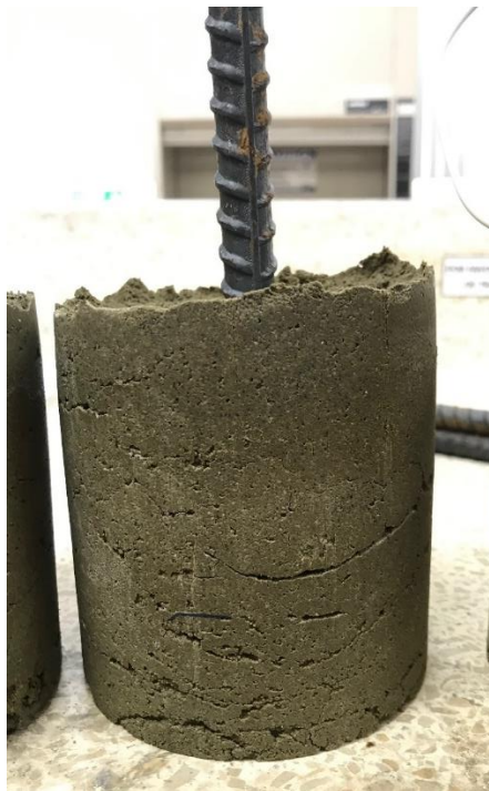
Ilustración C.2 Superficie de cilindro de geopolímero sin inhibidor antes del ensayo de corrosión acelerada - muestra 2
