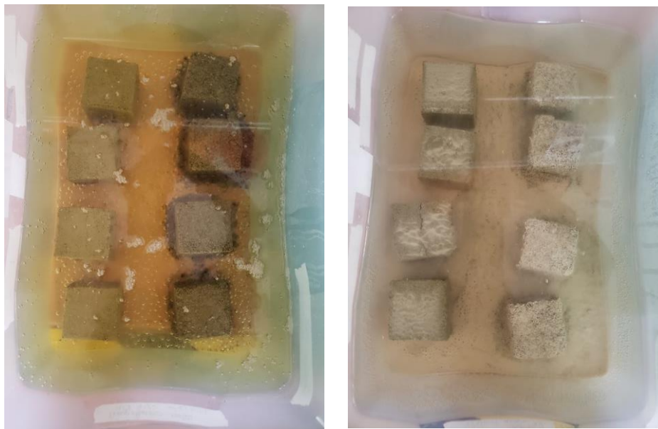
Ilustración J.2 Ensayo de resistencia a los diferentes ambientes con avance de un mes: Ácido clorhídrico 3%, Ácido sulfúrico 3% respectivamente
