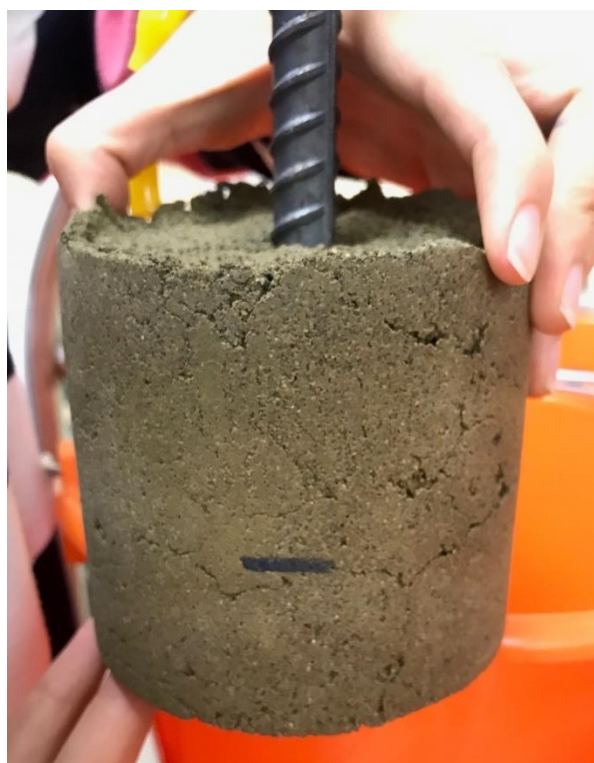
Ilustración C.4 Superficie de cilindro de geopolímero con inhibidor antes del ensayo de corrosión acelerada – muestra 1
