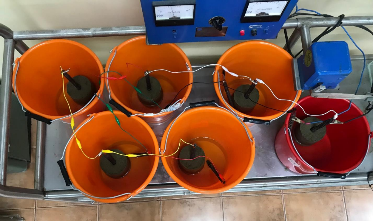
Ilustración C.7 Vista del sistema de corrosión acelerada para las muestras de geopolímero
