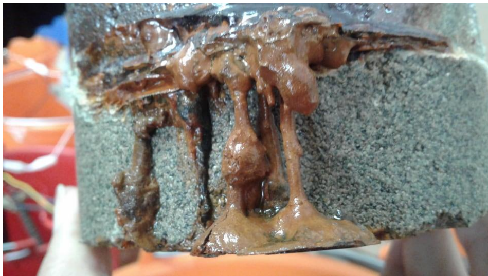
Ilustración E.2 Muestra de mortero de cemento sin inhibidor con rompimiento a los 27 días -replica 1
