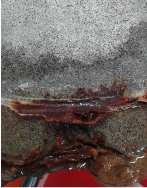
Ilustración E.3 Muestra de mortero de cemento sin inhibidor con rompimiento a los 27 días- replica 2
