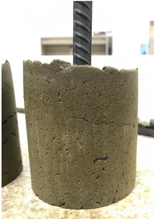
Ilustración C.1 Superficie de cilindro de geopolímero sin inhibidor antes del ensayo de corrosión acelerada-muestra 1
