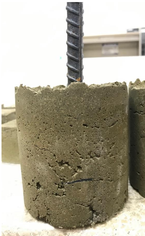
Ilustración C.3 Superficie de cilindro de geopolímero sin inhibidor antes del ensayo de corrosión acelerada - muestra 3
