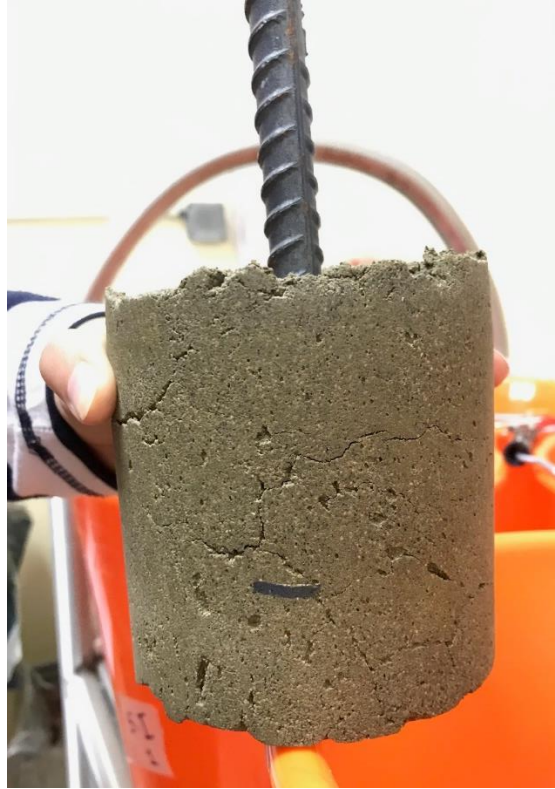
Ilustración C.5 Superficie de cilindro de geopolímero con inhibidor antes del ensayo de corrosión acelerada – muestra 2
