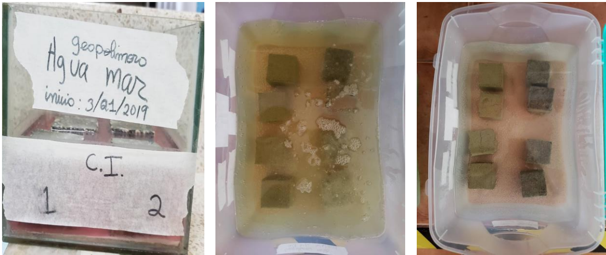
Ilustración J.1 Ensayo de resistencia inicial a los diferentes ambientes: agua de mar, Ácido clorhídrico 3%, Ácido sulfúrico 3% respectivamente
