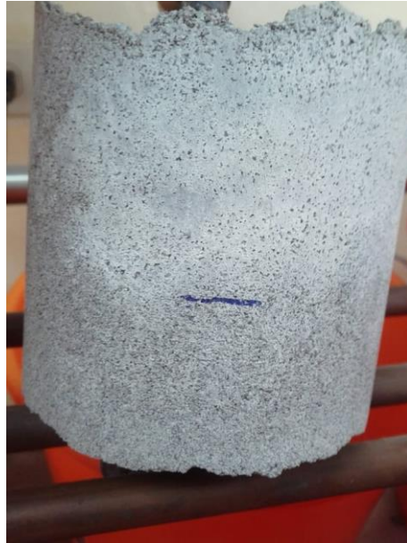
Ilustración D.1 Superficie de cilindro de cemento sin inhibidor antes del ensayo de corrosión acelerada – muestra 1
