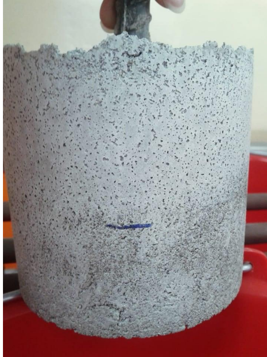
Ilustración D.5 Superficie de cilindro de cemento con inhibidor antes del ensayo de corrosión acelerada – muestra 2
