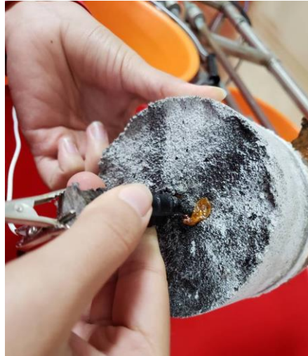
Ilustración E.1 Manifestación del producto de la corrosión por los espacios entre la mezcla de concreto y la varilla en muestra de cemento con inhibidor a los 20 días
