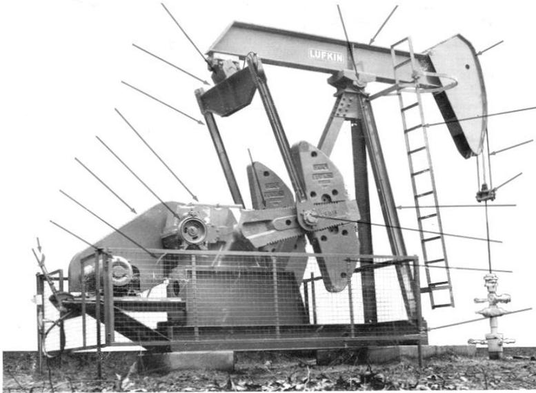
**Figura1.20 Unidad de Bombeo Mecánico Convencional**
