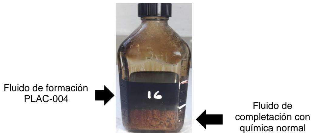
**Figura 3.8. Resultado de la mezcla prueba 16 del PLAC-004** [Dynadrill S.A., 2018]
