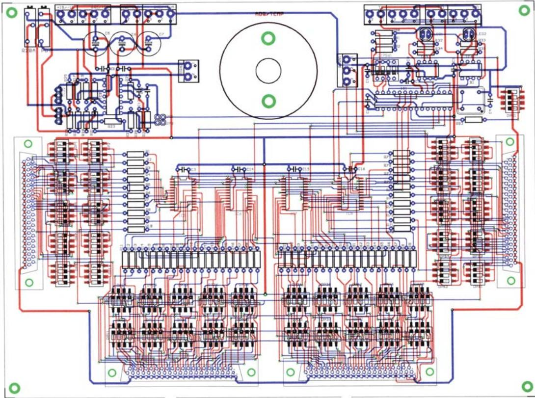
Figura D.2.2- Pistas de la Tarjeta de Adquisición de Datos de Temperatura
