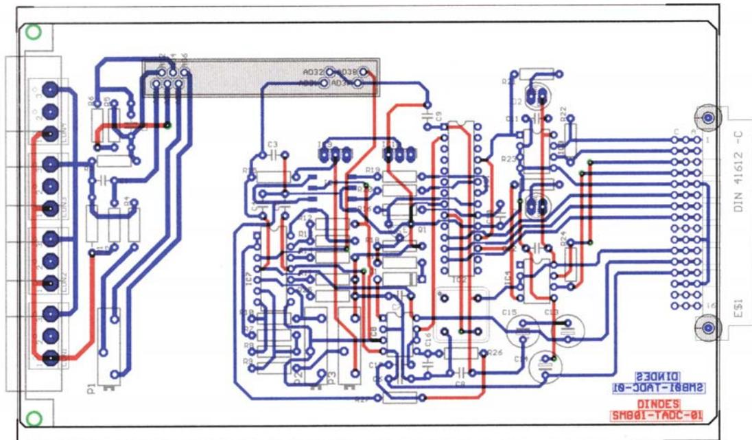
**Figura D.3.3-** Pistas de la Tarjeta de Adquisición de Datos de Corriente
