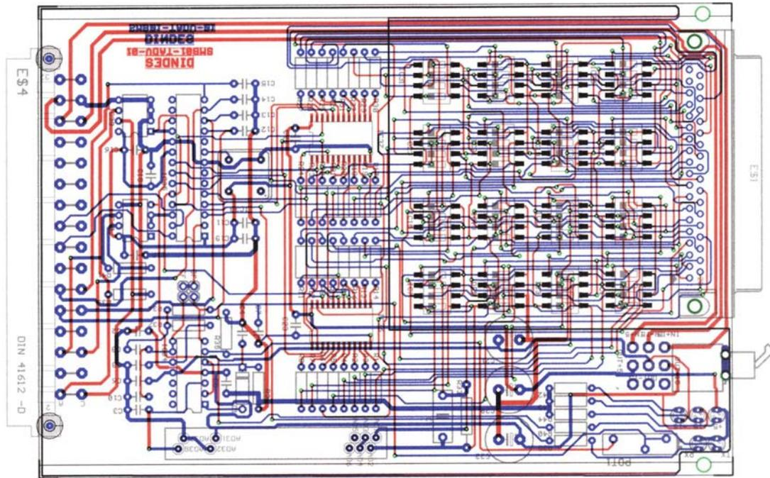
**Figura D.1.3-** Pistas de la Tarjeta de Adquisición de Datos de Voltaje
