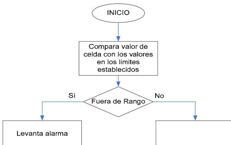
**Figura 4.6.** Diagrama lógico ASM del CASO6
