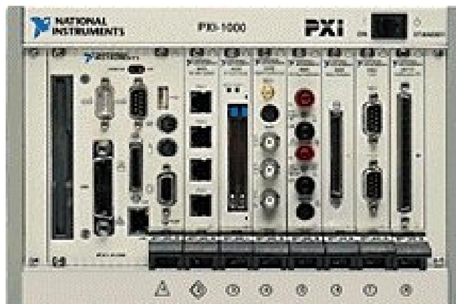
**Figura 1.2** PXI, Computador Industrial de National Instruments
