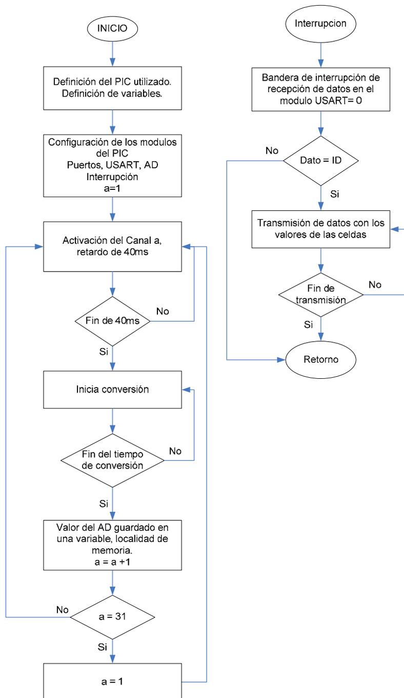
Figura 5.4. Diagrama de Bloques Lógico para la TADV
