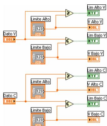
**Figura 5.19.** Diagrama de Bloques del caso de uso 6
