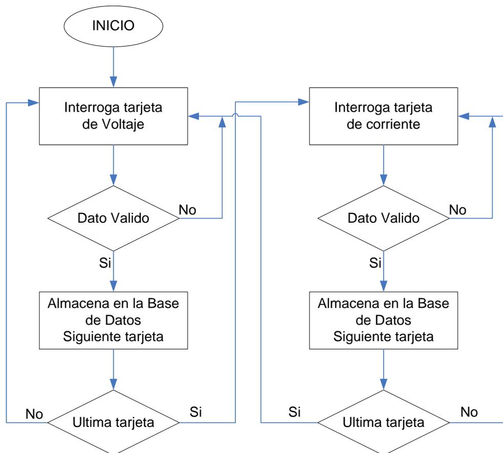
**Figura 4.1.** Diagrama lógico ASM del CASO1
