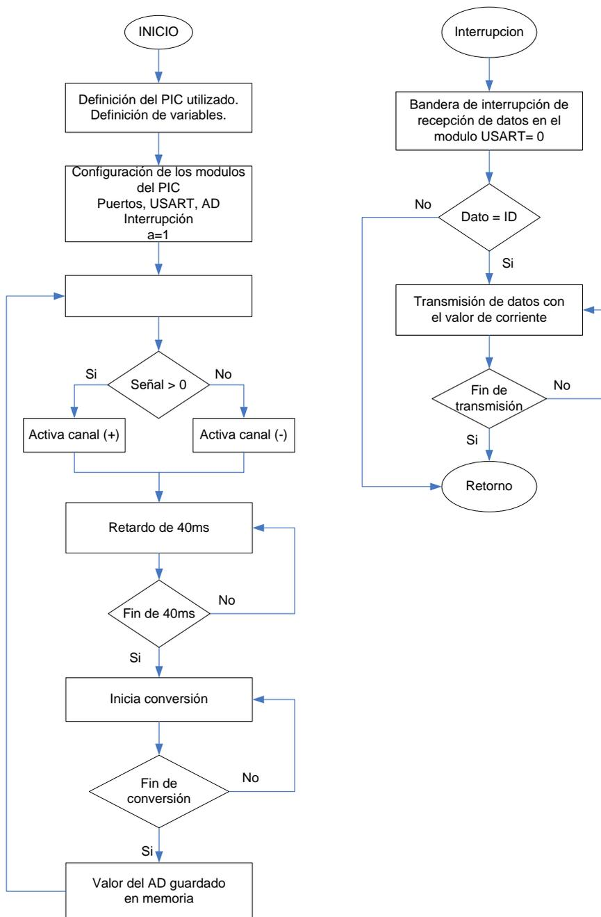
Figura 5.6. Diagrama de Bloques Lógico para la TADC
