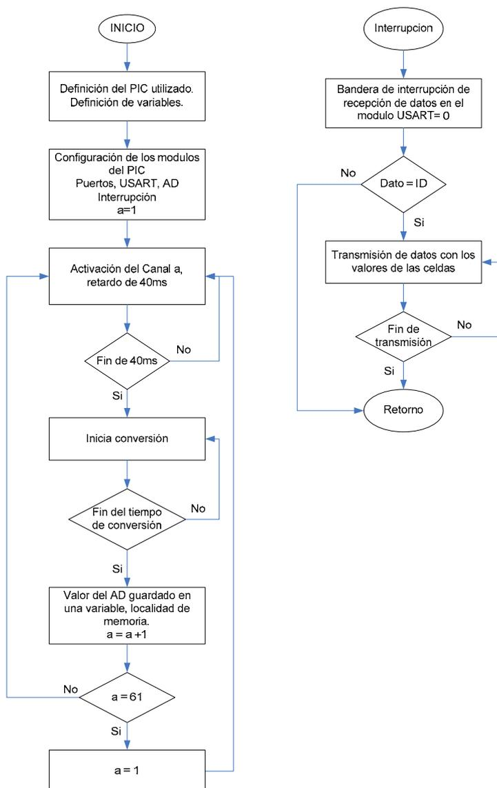
**Figura 5.5.** Diagrama de Bloques Lógico para la TADT
