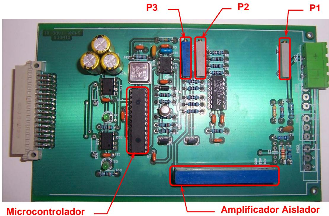
**Figura D.3.1-** Ensamblaje final de la Tarjeta de Adquisición de Datos de Corriente
