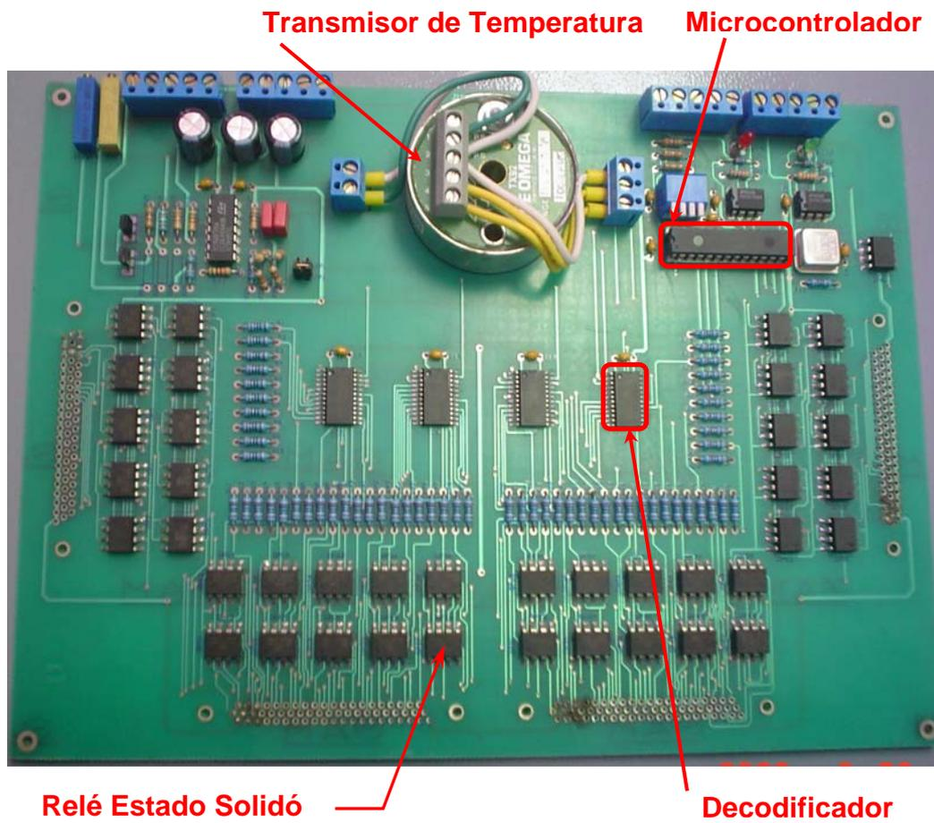
**Figura D.2.1-** Ensamblaje final de la Tarjeta de Adquisición de Datos de Temperatura
