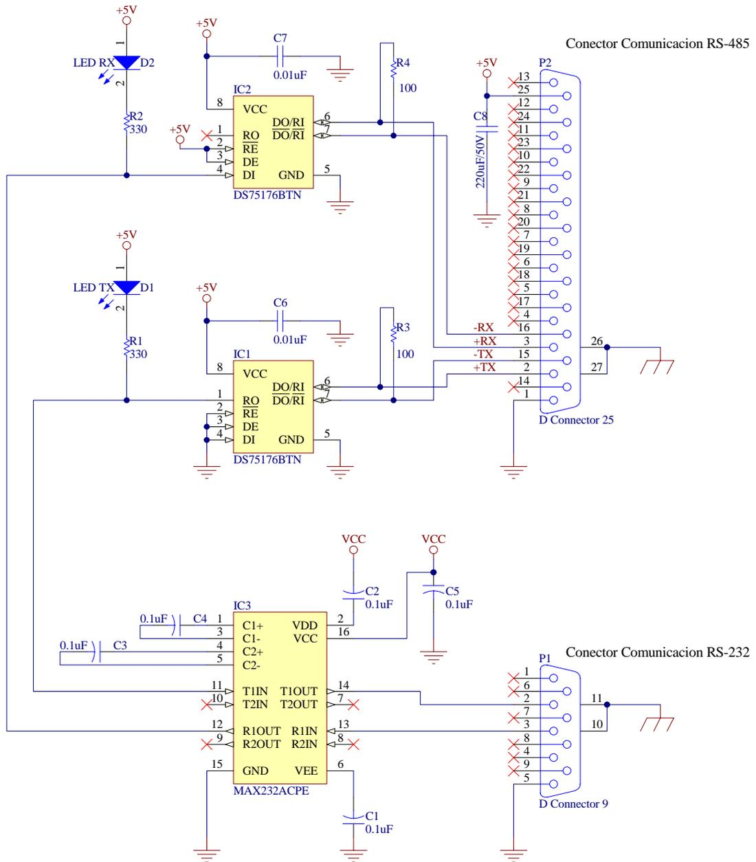
**Figura B.4.1-** DIAGRAMA ELECTRONICO DE LA TARJETA CONVERTIDOR DE INTERFASE RS-485 A RS-232
