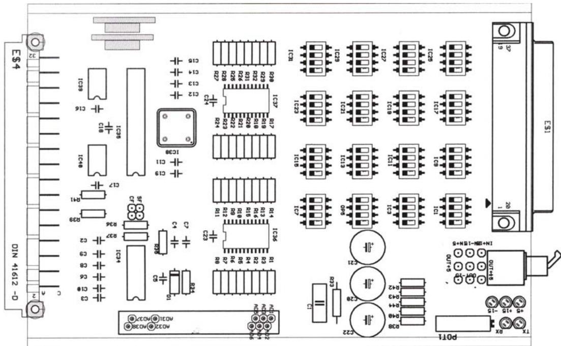
Figura D.1.4- Layout de la Tarjeta de Adquisición de Datos de Voltaje
