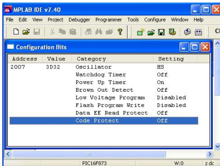
**Figura 5.3.** Configuración de Bits en el entorno MPLAB
