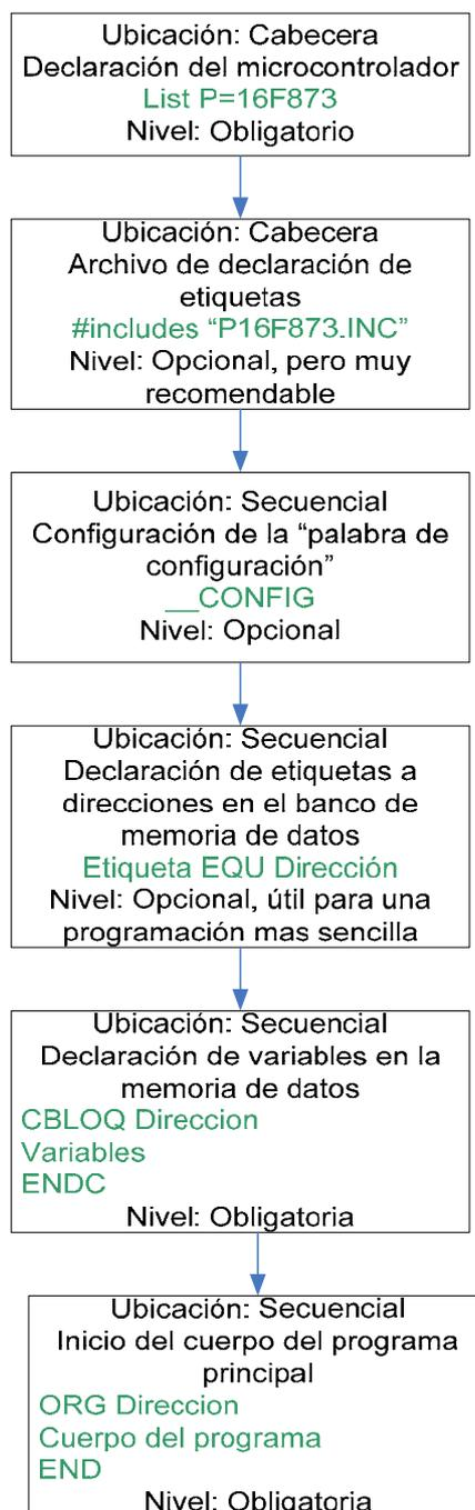
**Figura 5.1.** Estructura de programación de un microcontrolador
