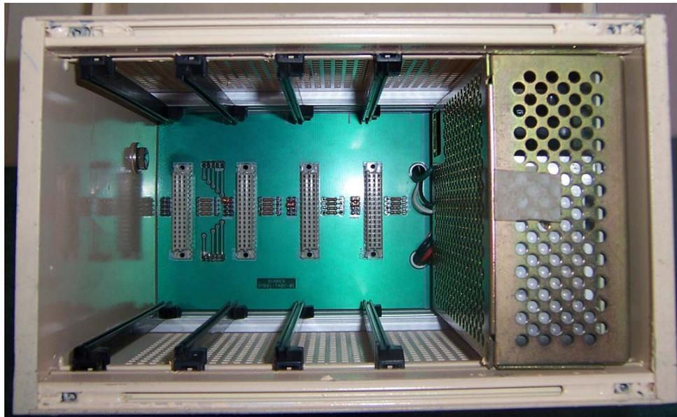
**Figura 3.18.-** RACK con Placa Base de Corriente
