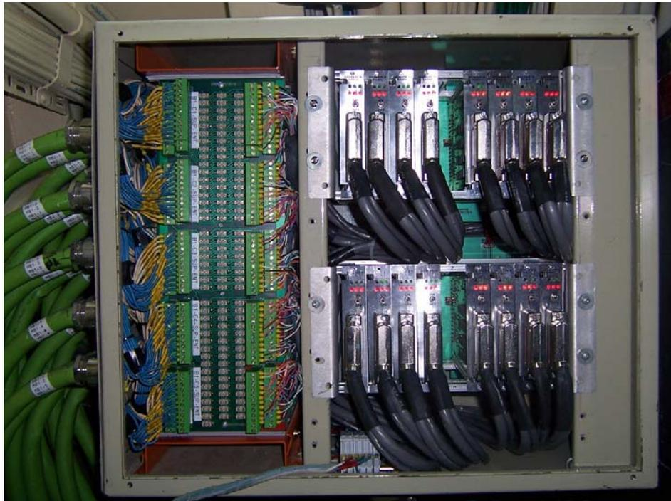
**Figura D.1.2-** Montaje de las 16 Tarjeta de Adquisición de Datos de Voltaje
