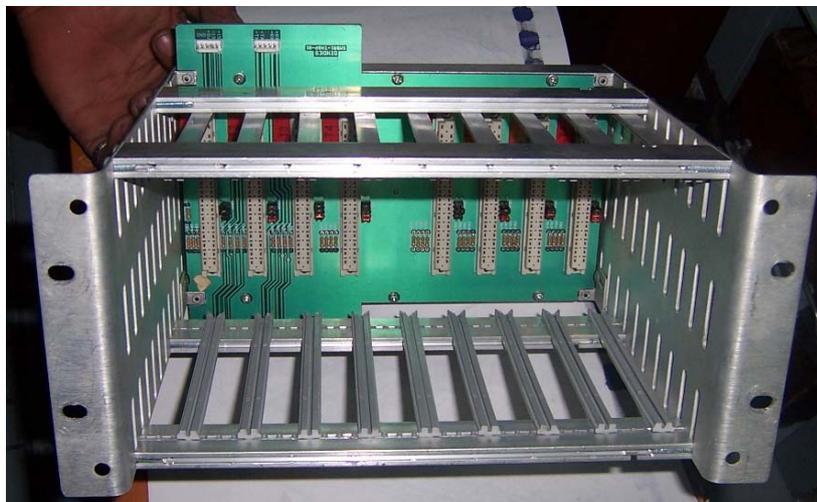
**Figura 3.17.- RACK con Placa Base de Voltaje**
