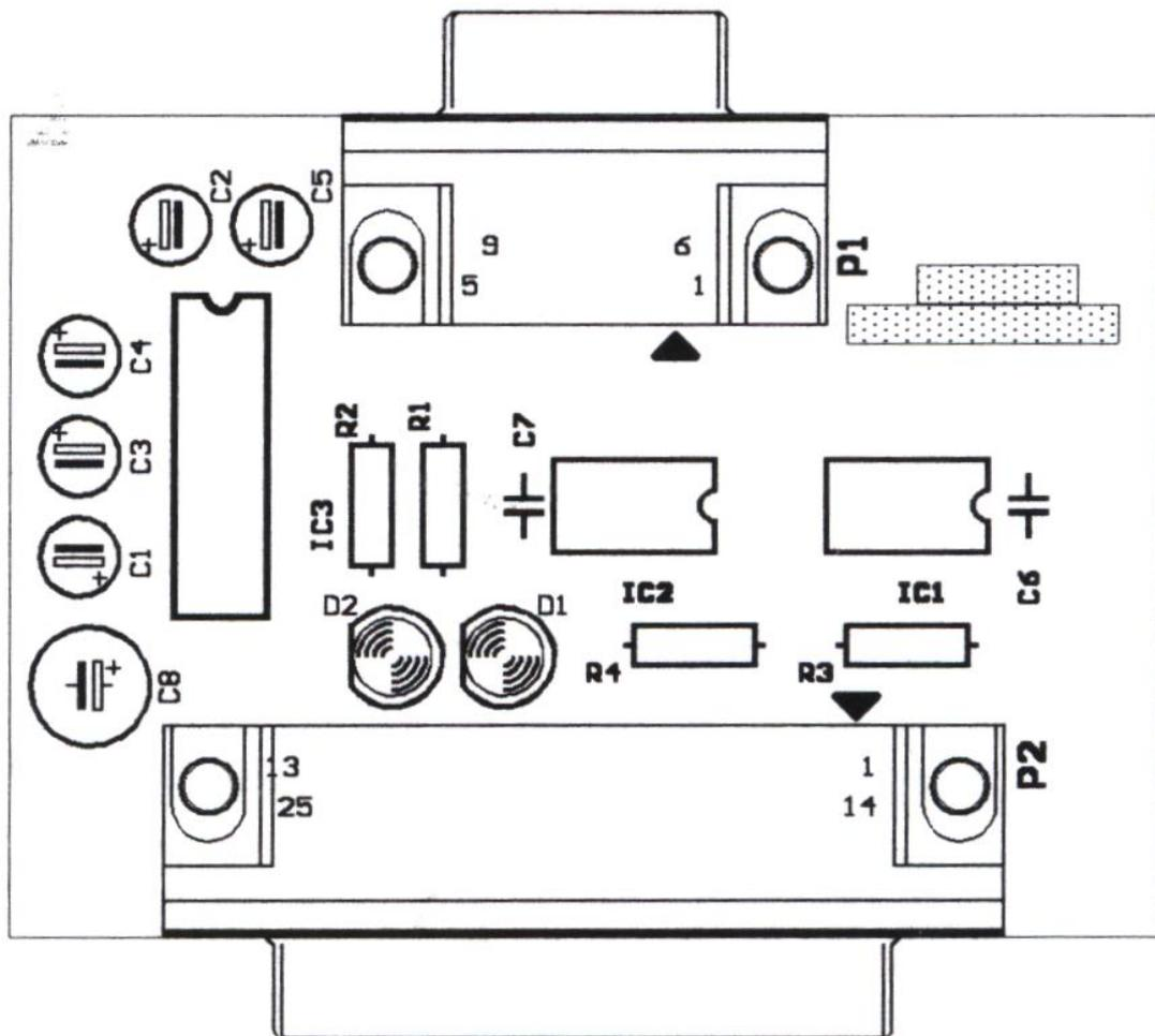
**Figura D.4.3-** Layout de la Tarjeta Convertidor de Interfase RS-485 a RS-232
