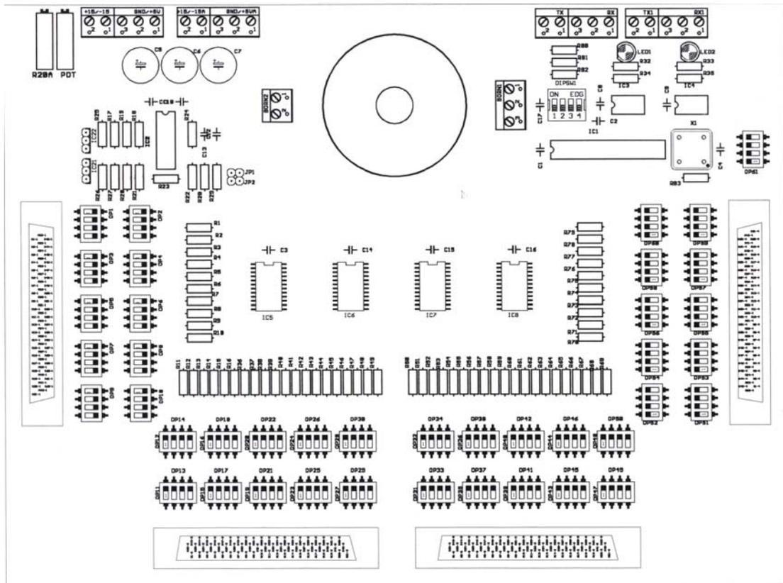
Figura D.2.3- Layout de la Tarjeta de Adquisición de Datos de Temperatura
