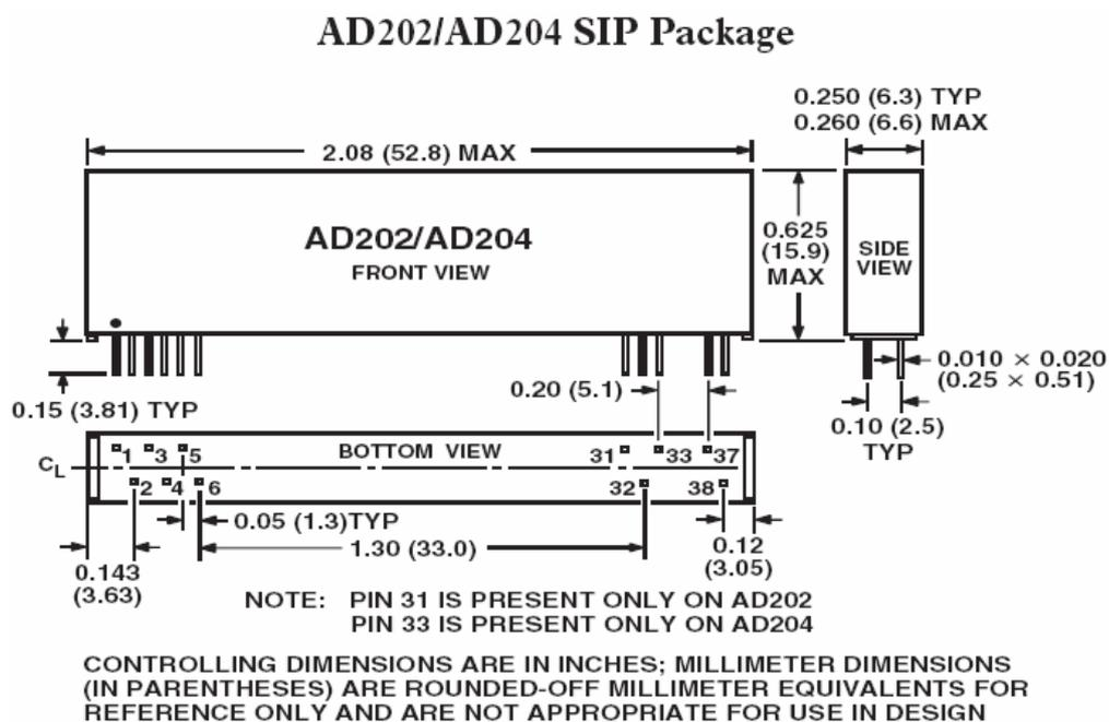
**Figura A.1.8-** Diagrama de pines para el amplificador aislador
