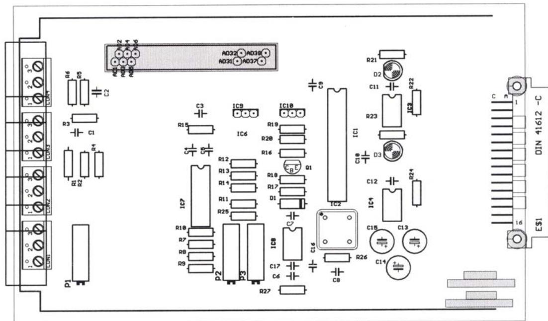
**Figura D.3.4-** Layout de la Tarjeta de Adquisición de Datos de Corriente
