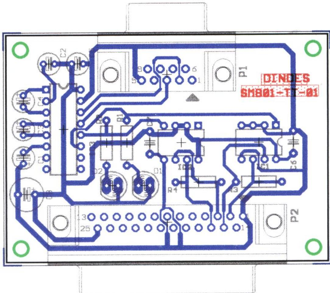
Figura D.4.2- Pistas de la Tarjeta Convertidor de Interfase RS-485 a RS-232
