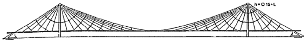
Puente mixto (cable net system)
