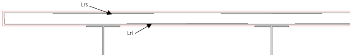
Ilustración 3-4 Longitud de Refuerzo.
