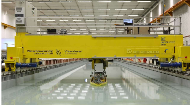
Figura 1.1 Canal de Pruebas Hidrodinámicas de la Universidad de Gante(Bélgica), construido en 1992
