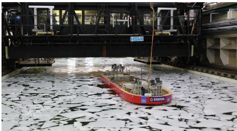
Figura 1.2 Canal de pruebas hidrodinámicas para hielo del laboratorio HSVA(Alemania), construido en 1972
