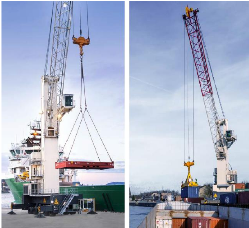
Imagen 2.9.- Grúa tipo Gottwald modelo 2. (KONECRANES, 2020)
