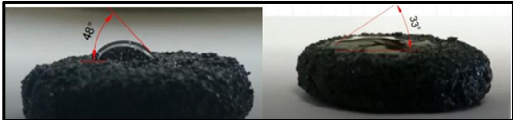
Figura 3.6 Variación de ángulo de contacto de roca oleofílica antes y después del filtrado.
