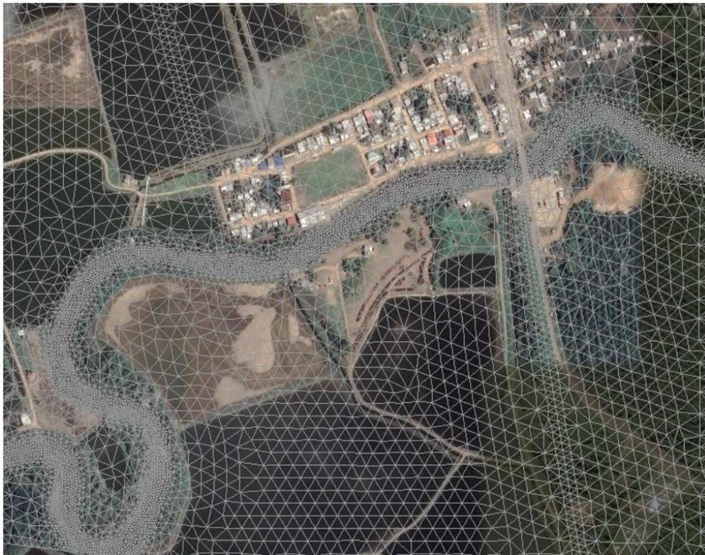
**Figura 2.12 Configuración de malla en el poblado y río de Salima.**
