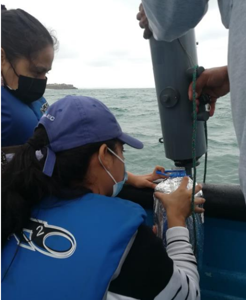
Ilustración A-1: Obtención de muestras de agua con la botella Niskin. Fuente: Las
