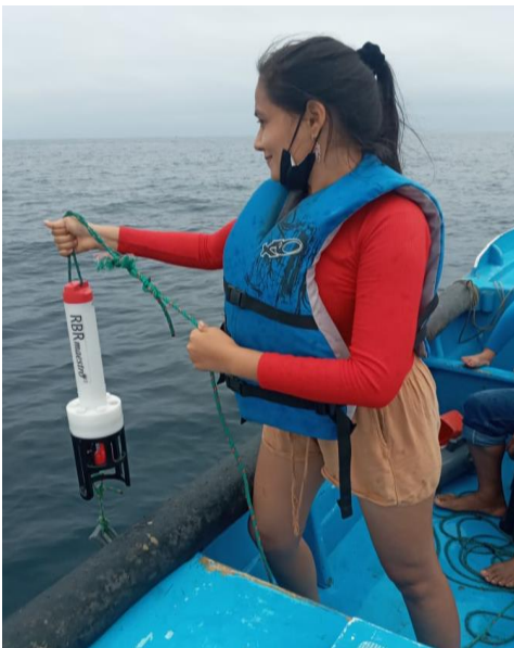
Ilustración A-3: Registro de datos con el multiparámetro. Fuente: Las Autoras.
