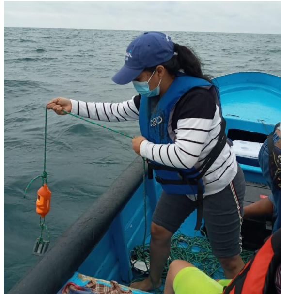
Ilustración A-2: Obtención de datos con el CTD. Fuente: Las Autoras.
