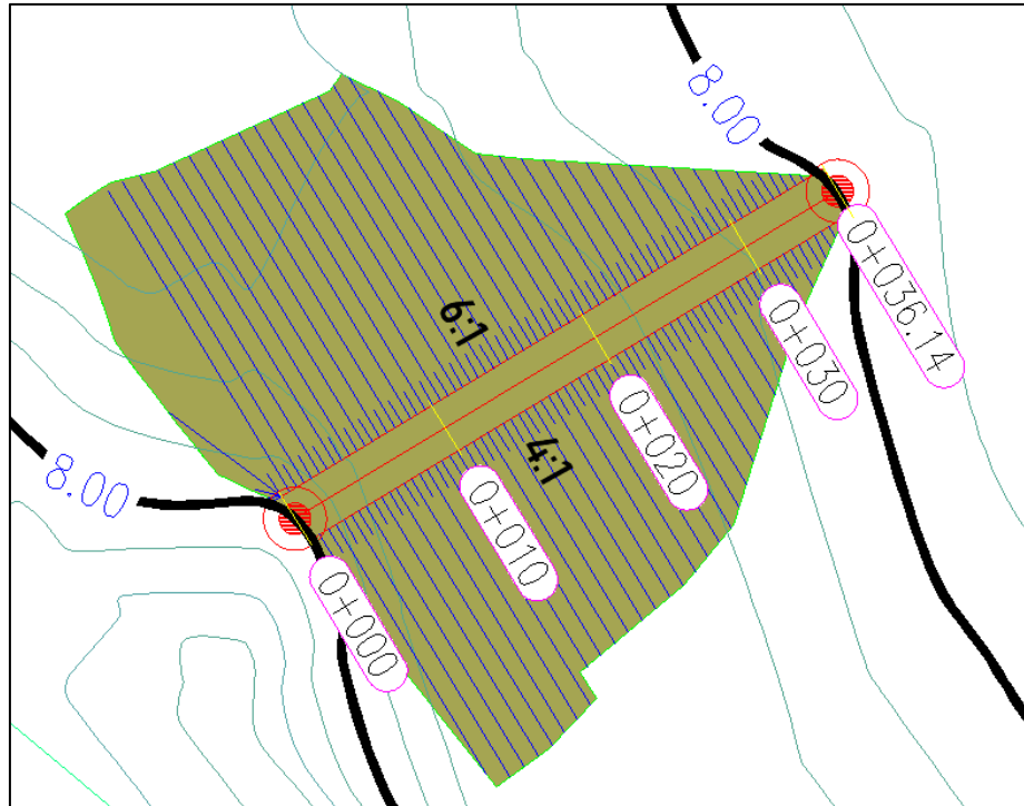
Figura 3.11 Cuerpo de presa “Alternativa B” sin aliviadero.
