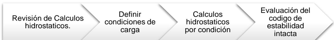
**Figura 2.30 Proceso de análisis de Arquitectura Naval**
