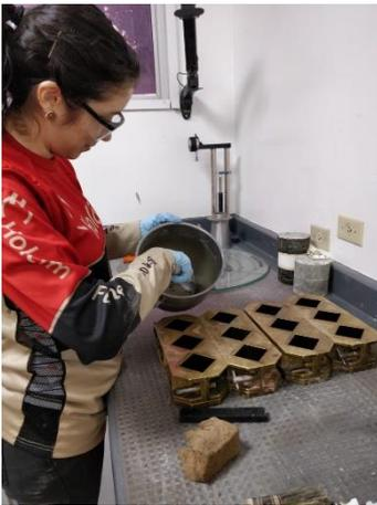
**Figura 2-8 Moldeo de Cubos de 50x50x50mm**
