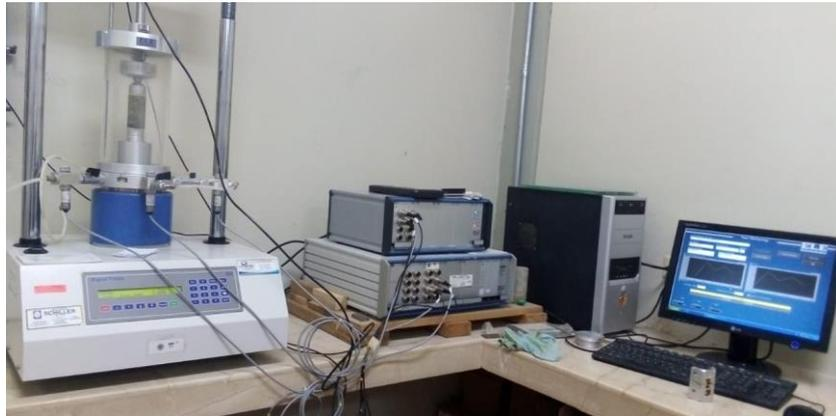
**Figura 2.7 Ensayo de Compresión Simple**
