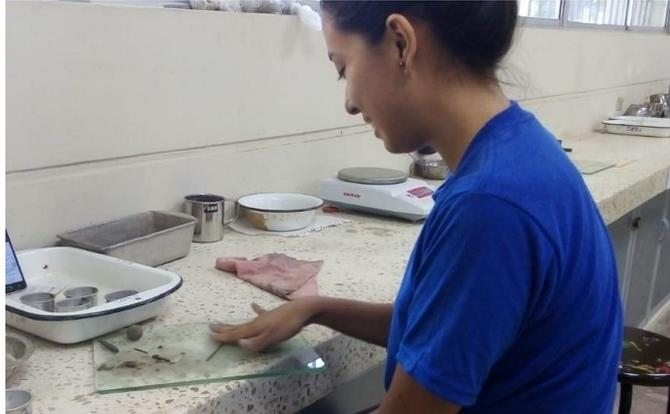
**Figura 2.4 Ensayo Límite Plástico**
