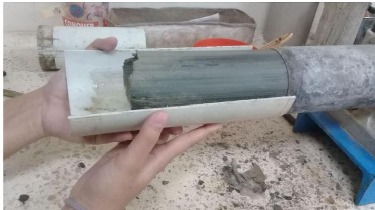
**Figura 2.2 Extracción de muestra del tubo shelby**
