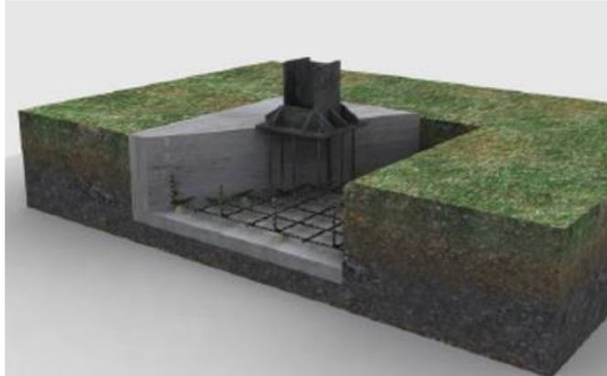
**Figura 2.46 Zapata aislada o individual**
