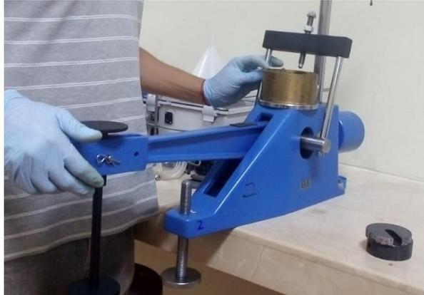
**Figura 2.5 Ensayo de Consolidación**
