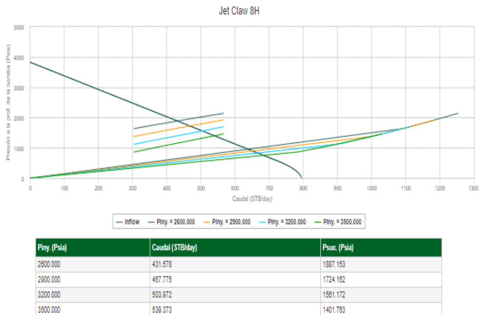
Figura 3.53 Análisis nodal para el sistema POWER WATER a 100 °F – POZO ESPOL 03.
