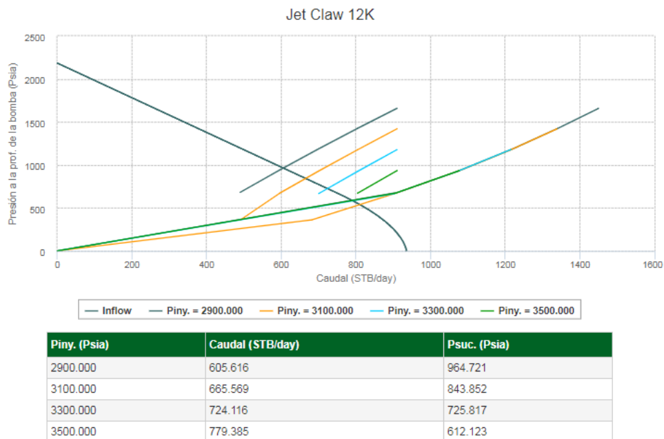
Figura 3.32 Análisis nodal para el sistema POWER WATER a 86 °F – Pozo ESPOL 01.
